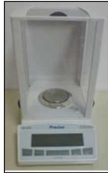
Şekil 6.7. Ağırlık kayıplarının belirlenmesinde kullanılan Precisa marka XS 220A model hassas terazi.
