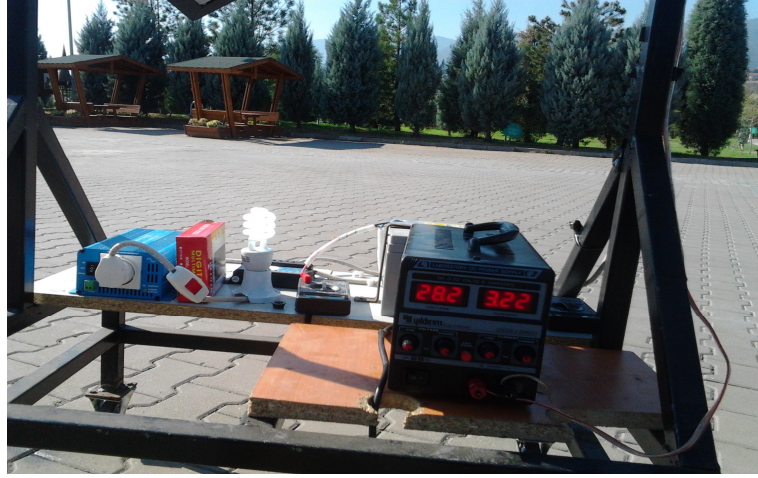
Şekil 5.11. Sistemin devreye girmesi için güç kaynağı ve sistem için gerekli olan voltaj ve akım değer aralıkları.
