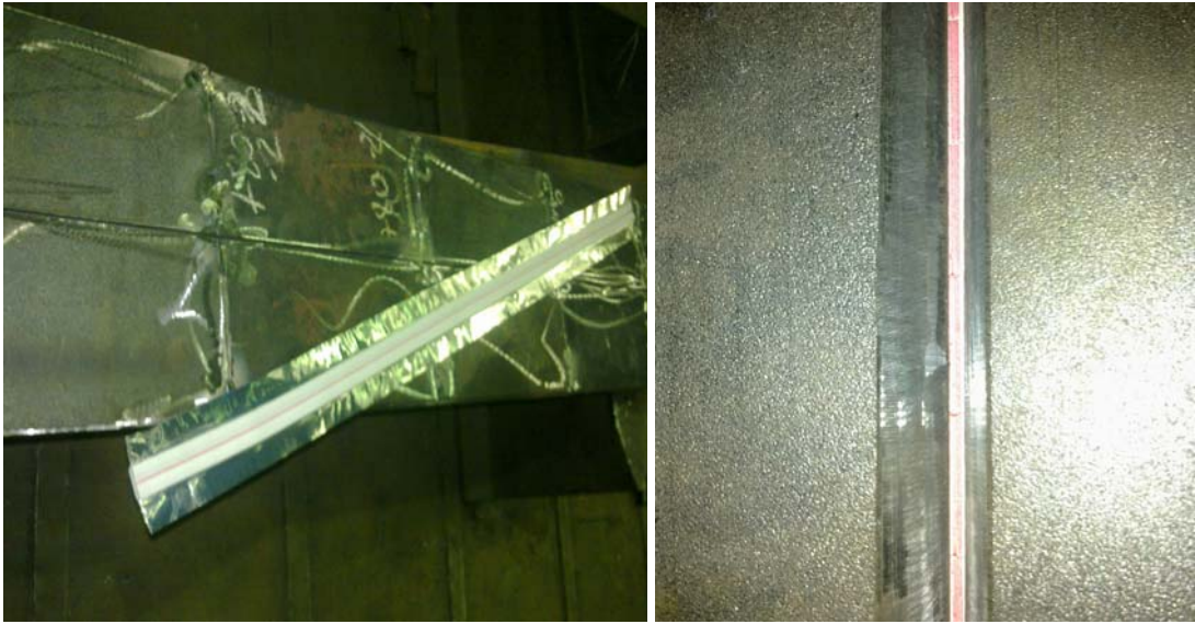
Şekil 6.6. Deney parçalarının puntalanması ve seramik altlığın kullanımı.
