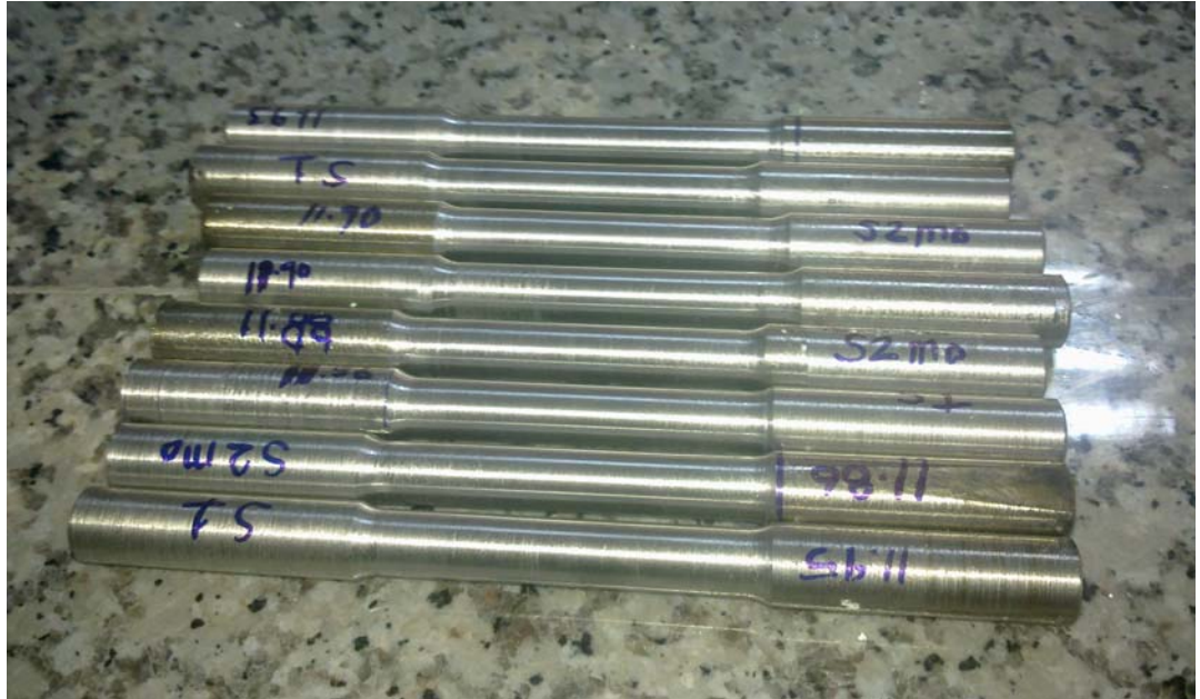
Şekil 6.25. Kaynak metalinden çıkarılmış ve TS EN ISO 6892-1'e göre hazırlanmış çekme deneyi numunelerinin görüntüleri.
