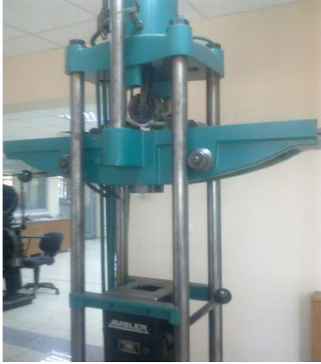
Őekil 6.26. Eđme deneylerinin yapıldıđı tezgah.
