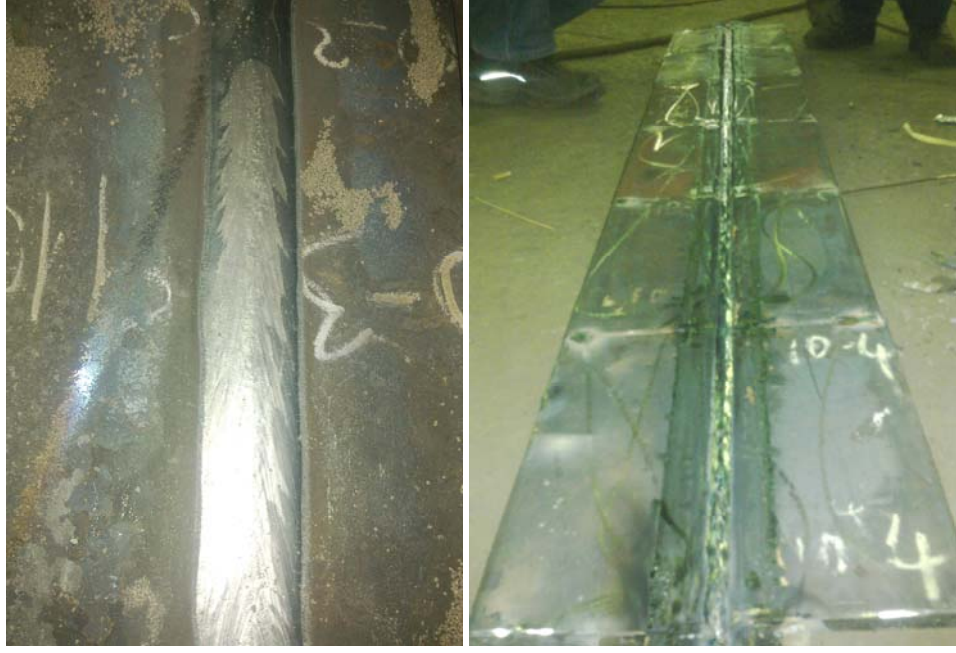
Şekil 6.9. Gözle muayene edilen parçaların kep ve kök kısmı (seramik altlığın kullanıldığı taraf).
