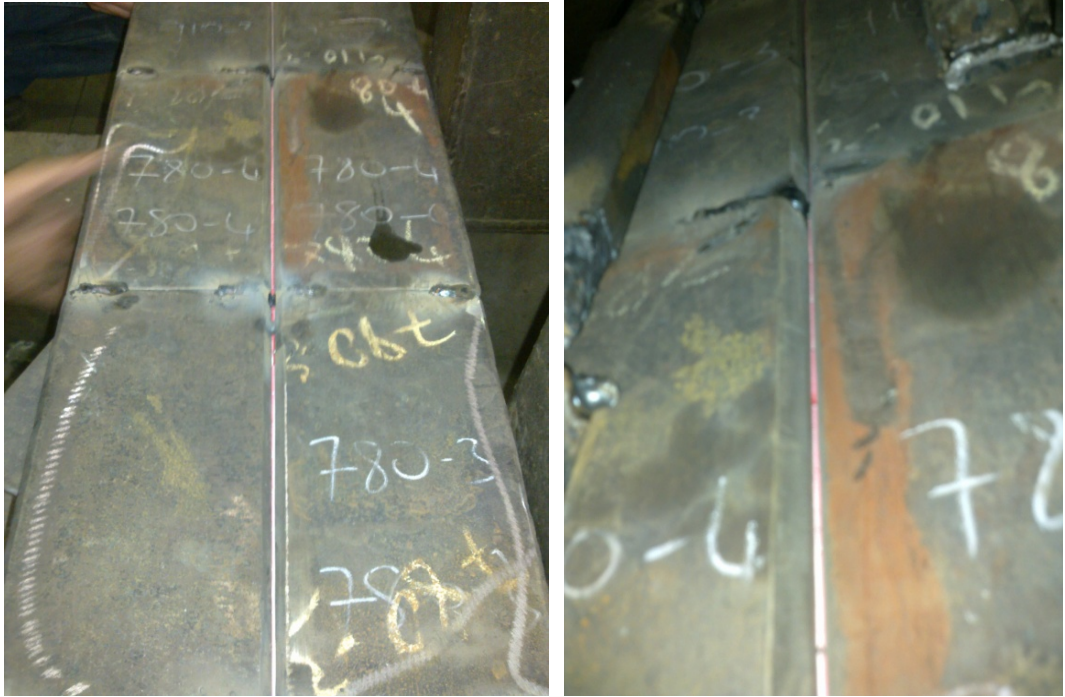
Şekil 6.2. 780 °C'deki sıcaklıklarda ısıtma işlemi görmüş deney numuneleri.
