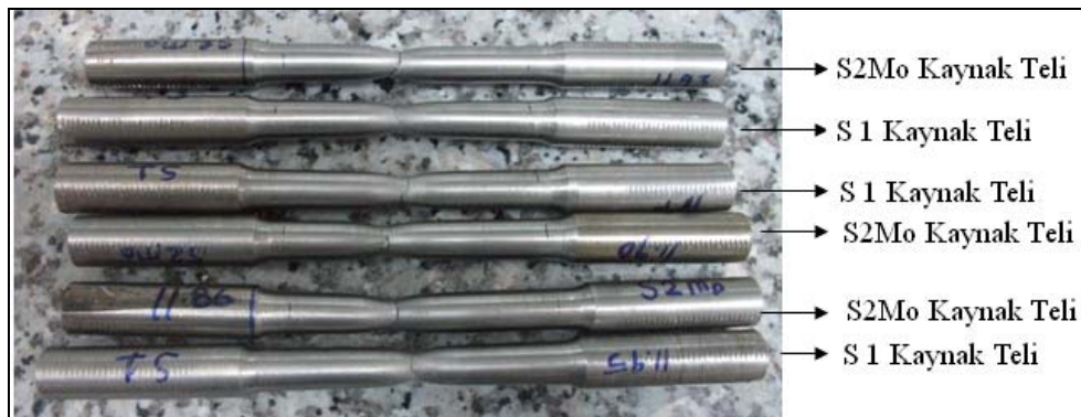
Şekil 7.15. Sadece kaynak bölgesinin çıkarıldığı parçalardan hazırlanmış silindirik çekme deneyi numunelerinin kopma bölgeleri.
