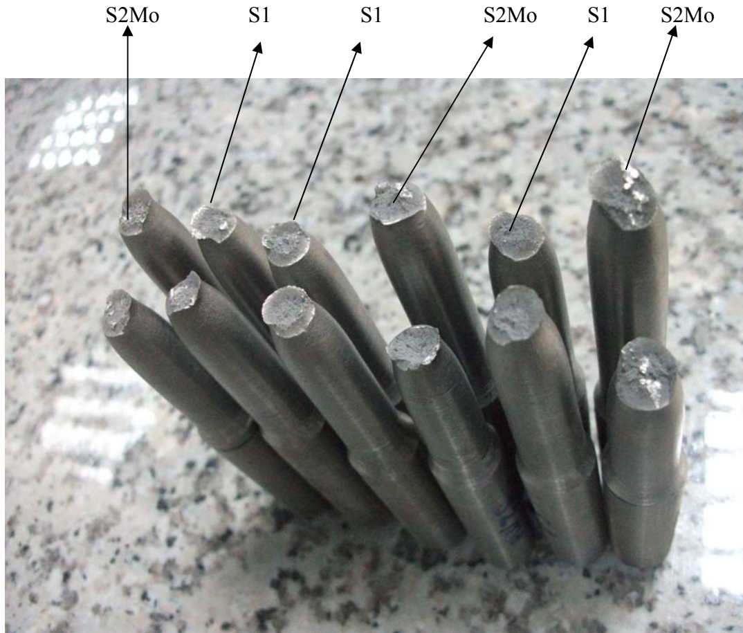
Şekil 7.16. Kaynak metalinden çıkarılan numunelerin “cup and cone” tarzı kopmuş yüzey görüntüleri.
