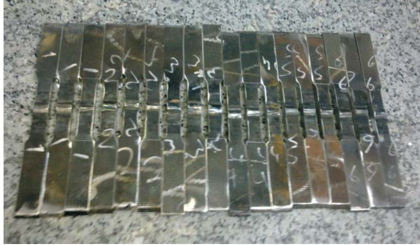
Şekil 6.22. Mekanik işlenerek hazırlanmış çekme deneyi numuneleri.
