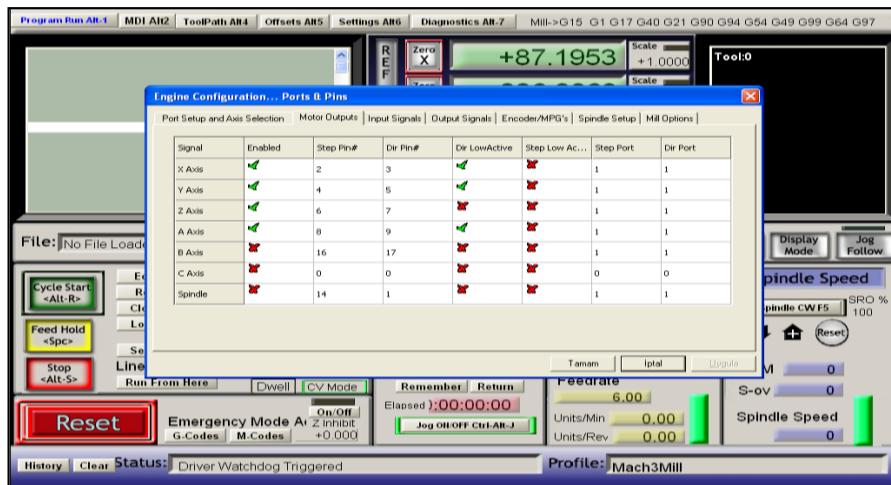
Şekil 3.22. Eksen ve port ayarlarının yapılması.
