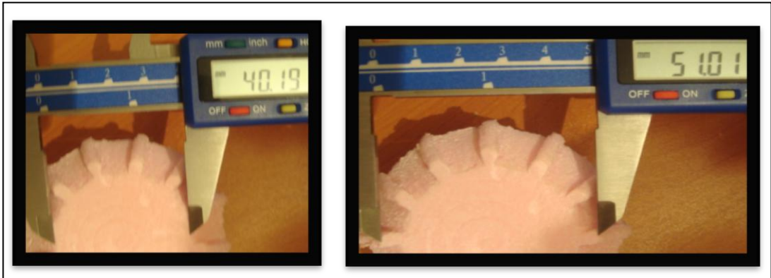
Şekil 6.15. 90° lik silindirik düz konik dişlinin diş üstü ve diş dibi çapı ölçüleri.
