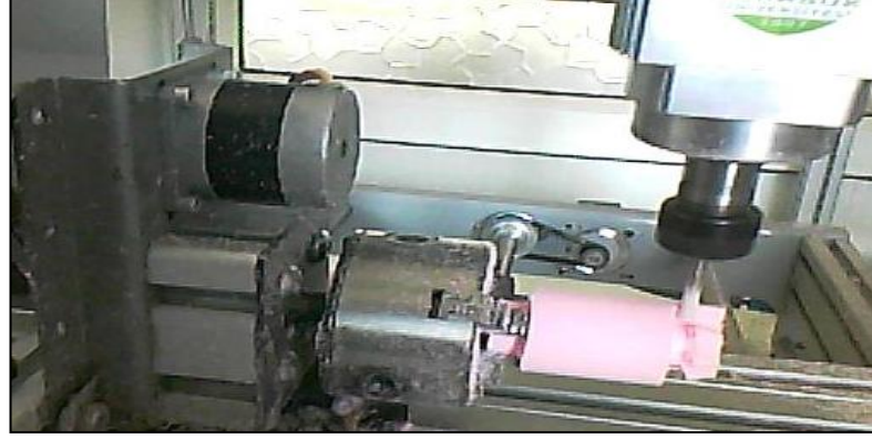
Şekil 5.15. Silindirik düz konik dişlinin tablaya bağlanması ve işlenmesi.
