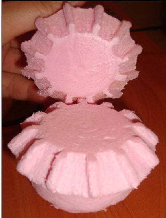
Şekil 6.27. Strofor malzemedan \delta=90^\circ olan düz konik dişli oluşturulması.
