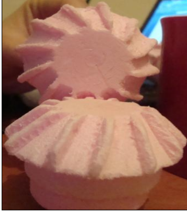
Şekil 6.26. Strofor malzemedan \delta=90^\circ olan helisel konik dişli oluşturulması.
