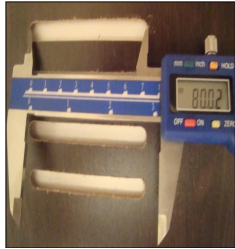
Şekil 6.2. X Ekseninde açılan kanallar. Şekil 6.3. X Ekseninde kanallardan ölçü.
