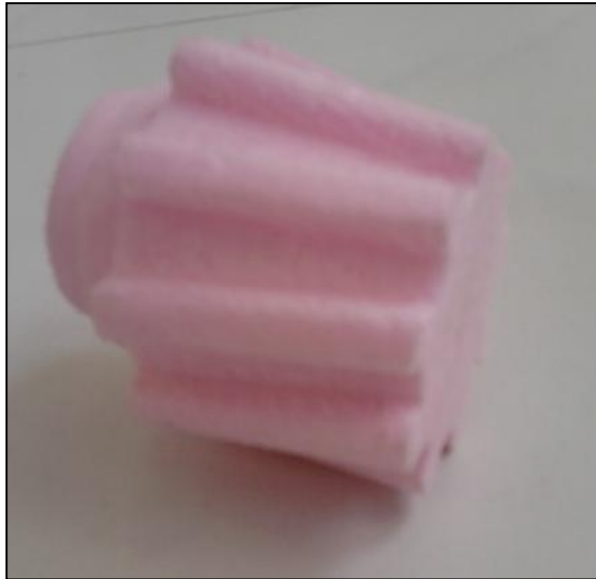
Şekil 6.23. Strofor malzemeden \delta < 90^\circ olan helisel konik dişi oluşturulması.
