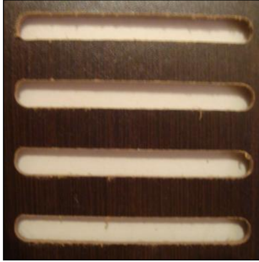
Şekil 6.2. X Ekseninde açılan kanallar. Şekil 6.3. X Ekseninde kanallardan ölçü.
