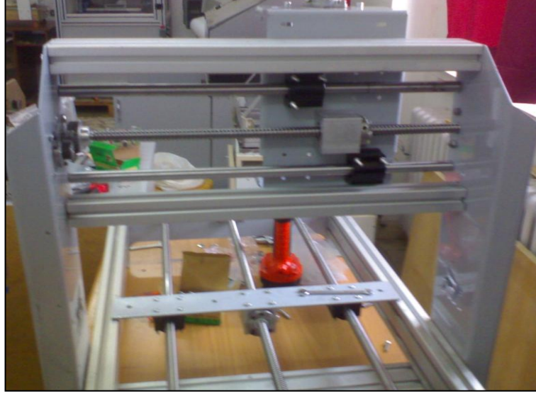
Şekil 3.6. Sistemdeki X ve Y eksenlerinin gövdeye montajı.
