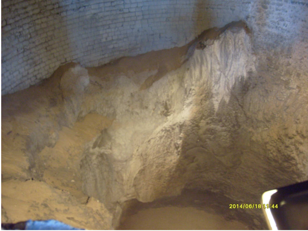
Şekil 5.2. 3 No'lu YF'da oluşmuş skaffold [24].
