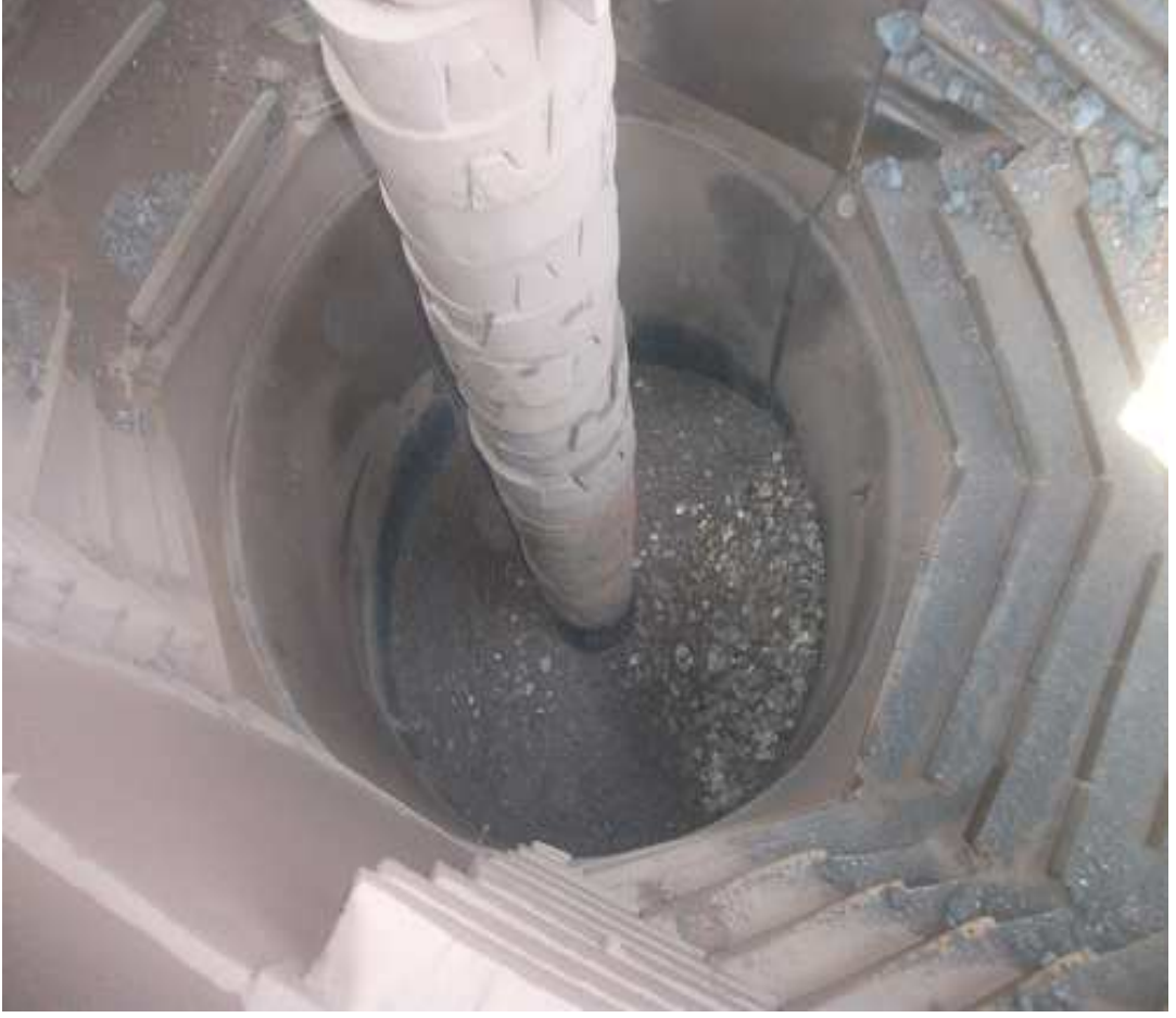
Şekil 8.18. 3 Nolu yüksek fırın küçük çan üzerinde homojen olmayan cevher dağılımı.
