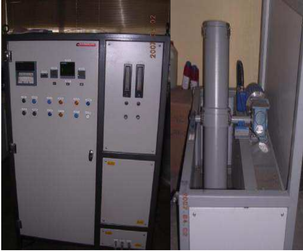
Şekil 8.4. Kok reaktivite cihazı ve tamburu.
