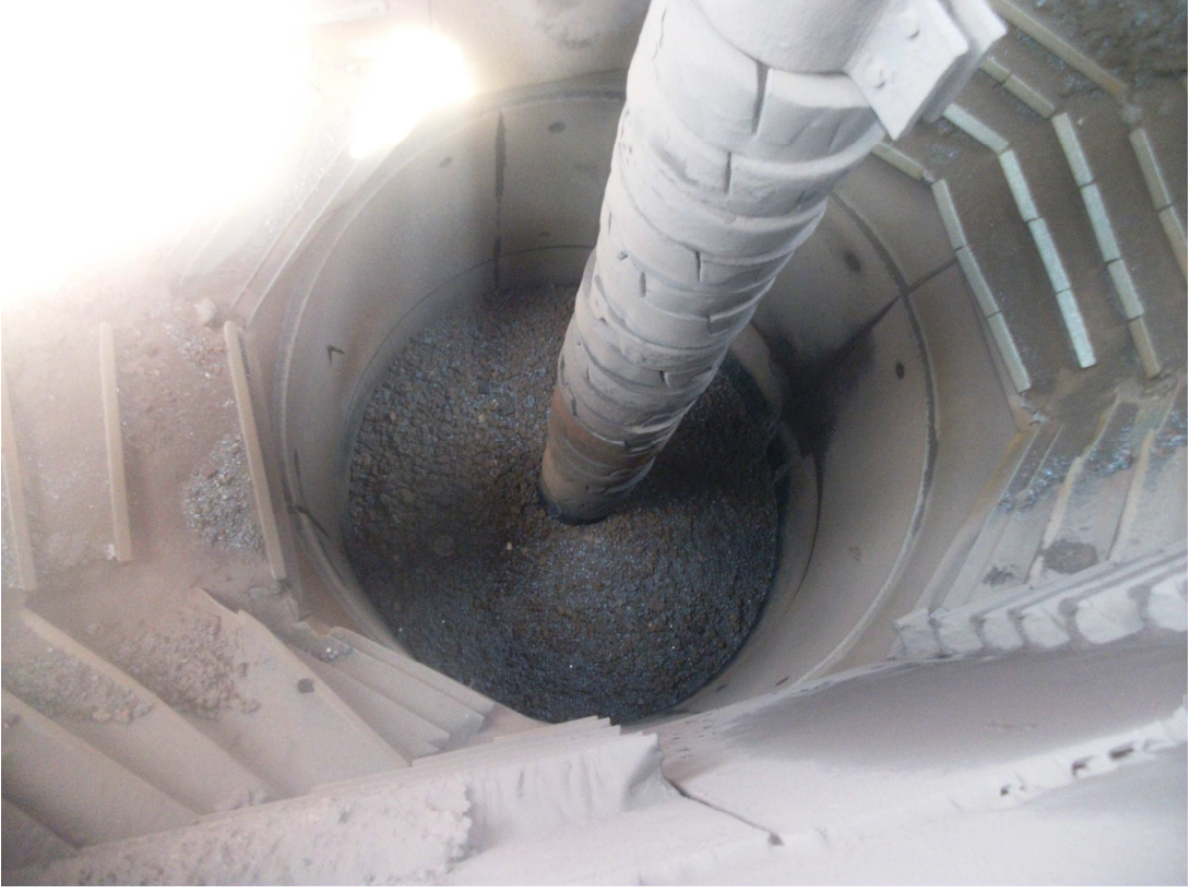
Şekil 8.19. 3 no'lu yüksek fırın küçük çan üzerinde homojen cevher dağılımı.
