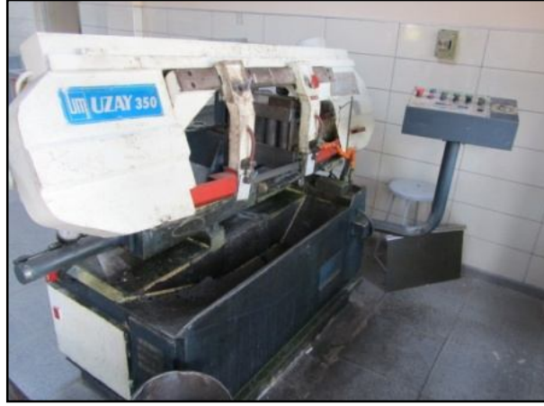
Şekil 4.3. Uzay makine uzay 350 model 350 mm ye kadar kesme çaplı tip SO 350 kesme cihazı.
