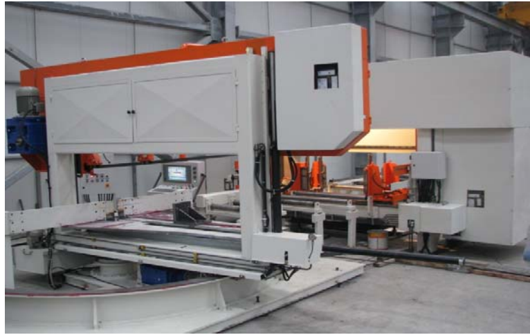
Şekil 2.2. Uygulamada kullanılan Profil Delme ve Kesme Makinesi görüntüsü.
