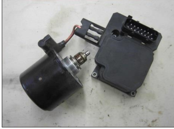
Şekil 5.7. ABS hidrolik pompa motoru.
