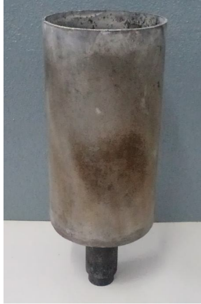
Şekil 5.2. Ergitme işleminde kullanılan çelik pota resmi.
