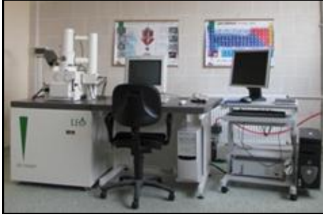
Şekil 5.6. Çalışmalarda kullanılan Tarama Elektron Mikroskobu.
