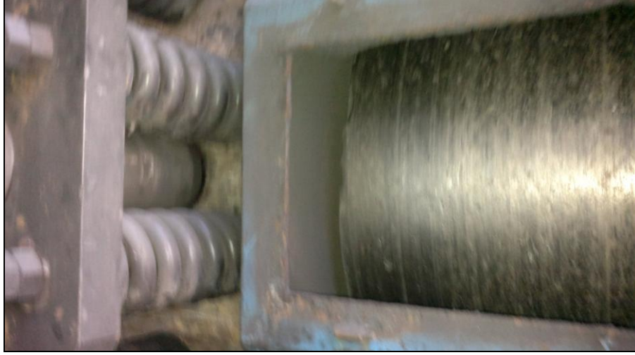
Şekil 6.19. Döküm(DKM2 ) merdanesi aşınma resmi.
