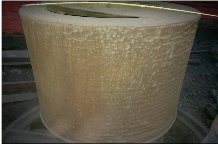
Şekil 6.22. Döküm(DKM5 ) merdanesi aşınma resmi.
