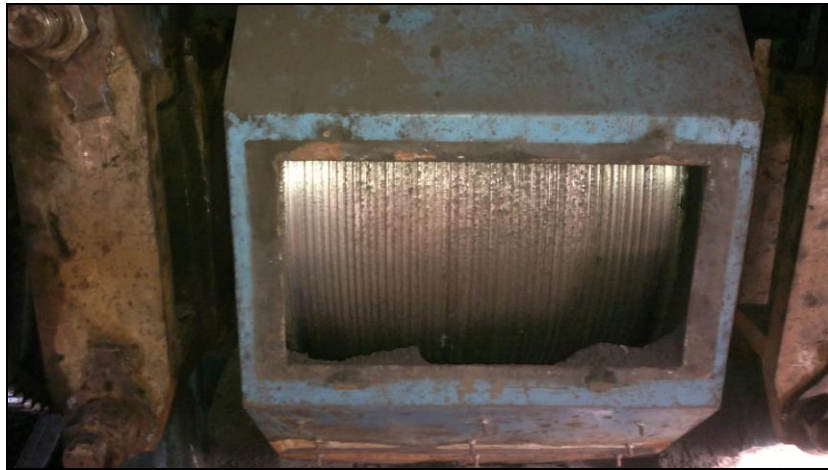
Şekil 2.20. Merdane yüzeyindeki aşınma resmi.
