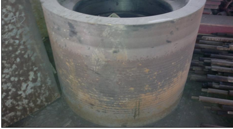
Şekil 6.21. Döküm(DKM4 ) merdanesi aşınma resmi.
