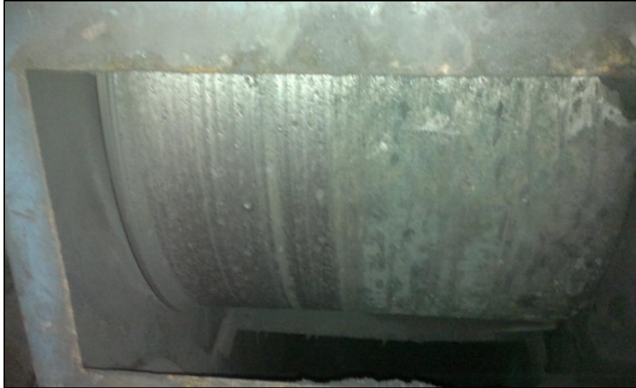
Şekil 6.20. Döküm(DKM3 ) merdanesi aşınma resmi.
