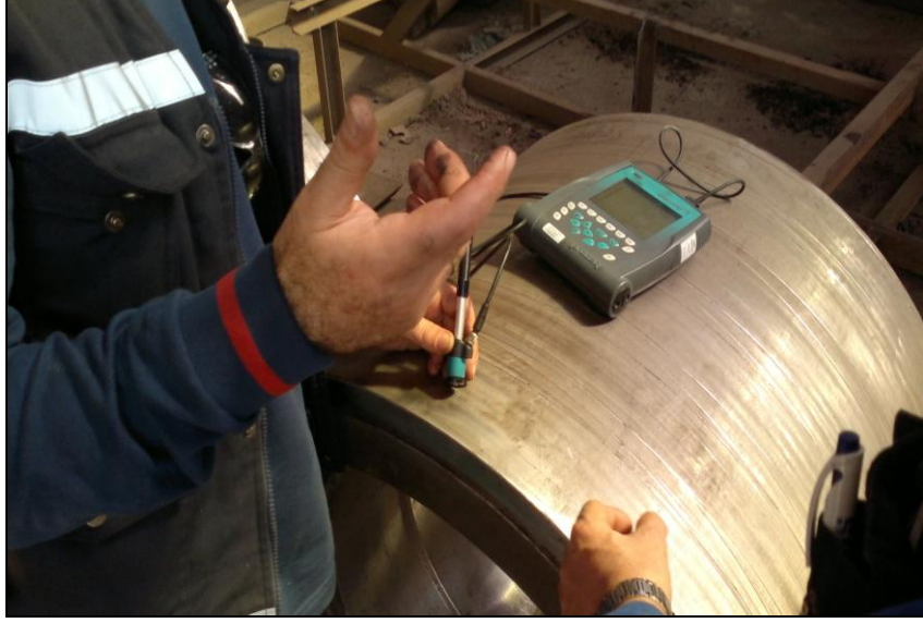
Şekil 6. 9.Merdane sertlik ölçüm resmi.
