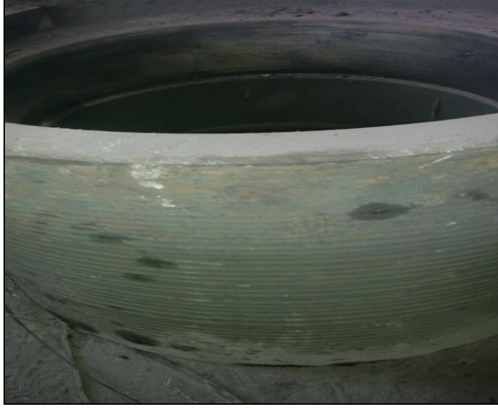
Şekil 6.23. Döküm(DKM6 ) merdanesi aşınma resmi.
