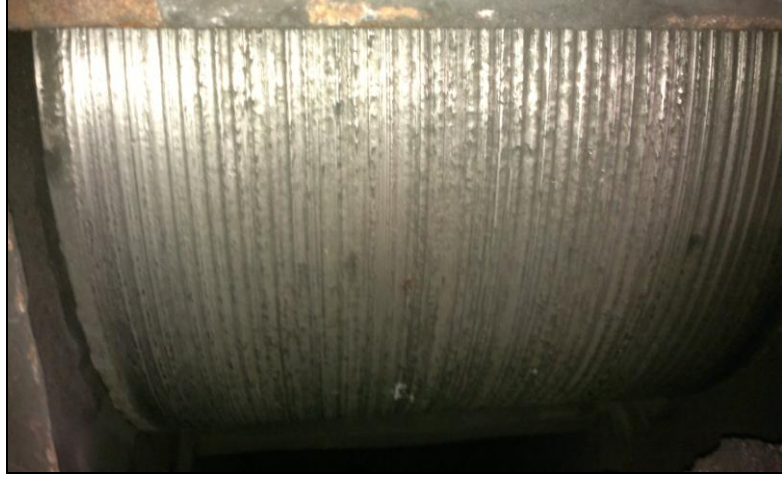
Şekil 2.18. Merdane yüzeyindeki aşınma resmi.
