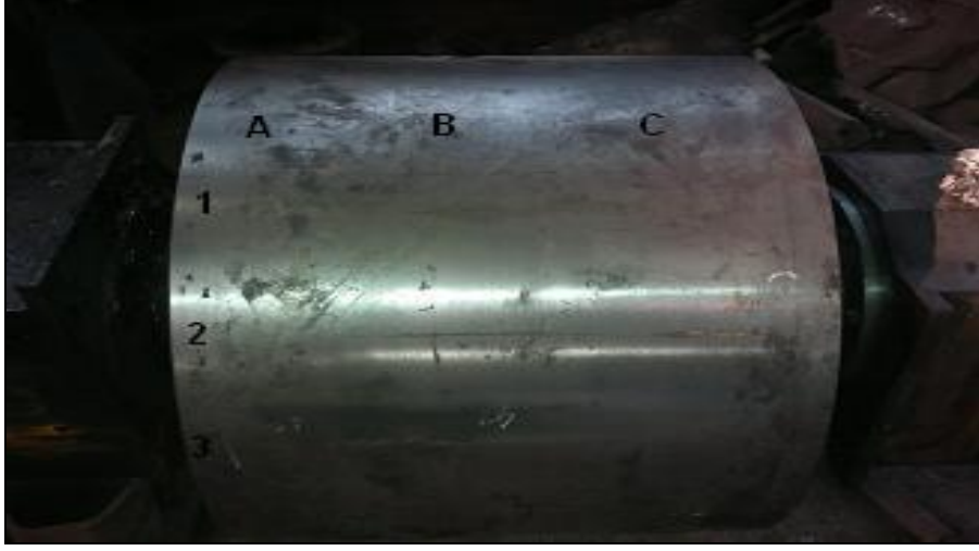
Şekil 6.7. Dökümler için alınan sertlik noktaları.
