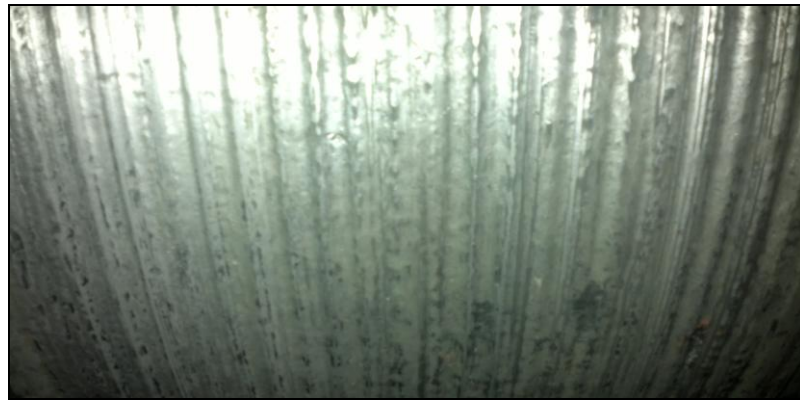
Şekil 2.17. Merdane yüzeyindeki aşınma resmi.
