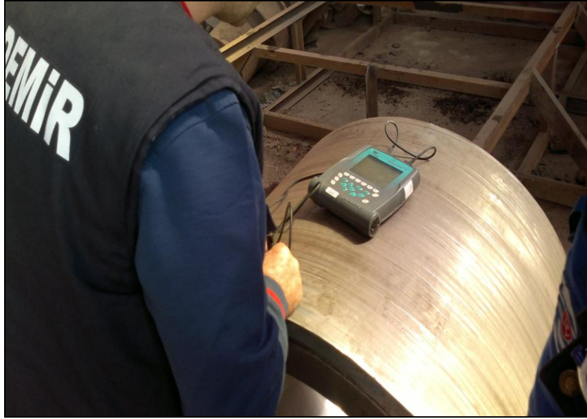
Şekil 6.8. Merdane sertlik ölçüm resmi.
