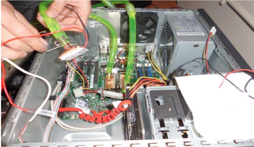
Şekil 6.5. Peltier modülün kuzey köprüsü üzerine monte edilmesi.
