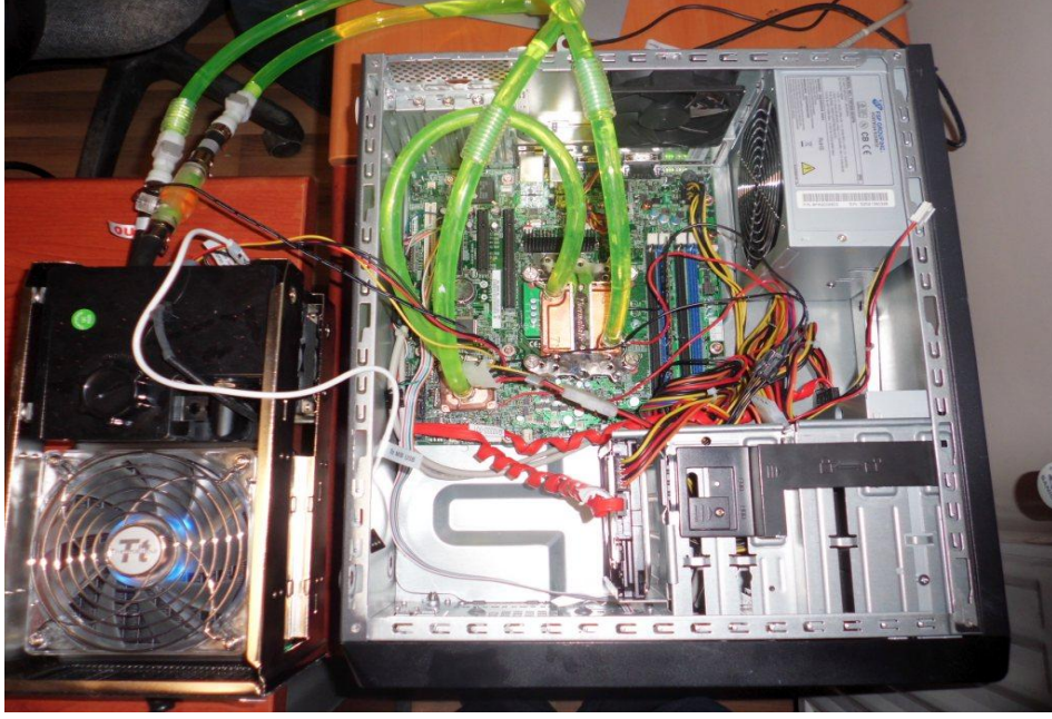
Şekil 6.2. Su soğutma sisteminin sunucu anakartına monte edilişi.
