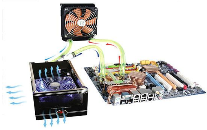
Şekil 5.2. Su soğutma sistemi.
