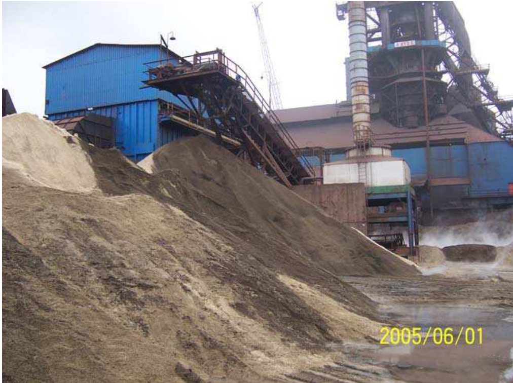
Şekil 5.7. Granüle cüruf sahası.
