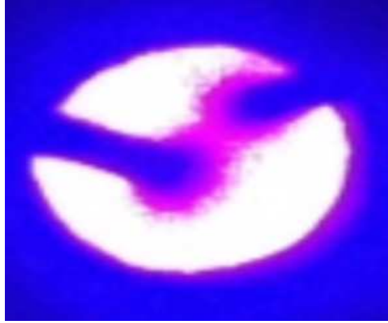
Şekil 5.13. Çift lanslı tüyerden bakıldığında görünen görüntü.
