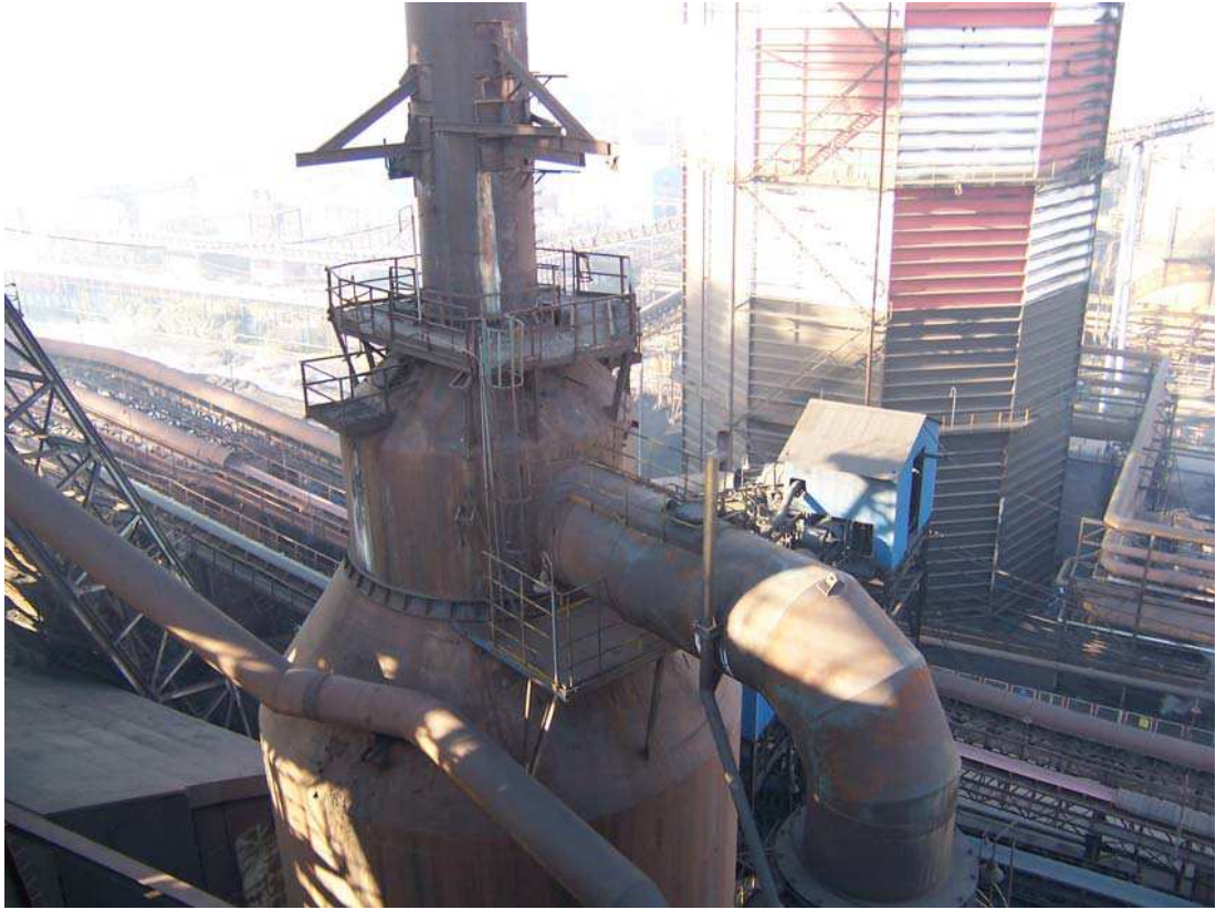
Şekil 5.9. Yüksek fırınlar baca gazı toz tutma sistemi.
