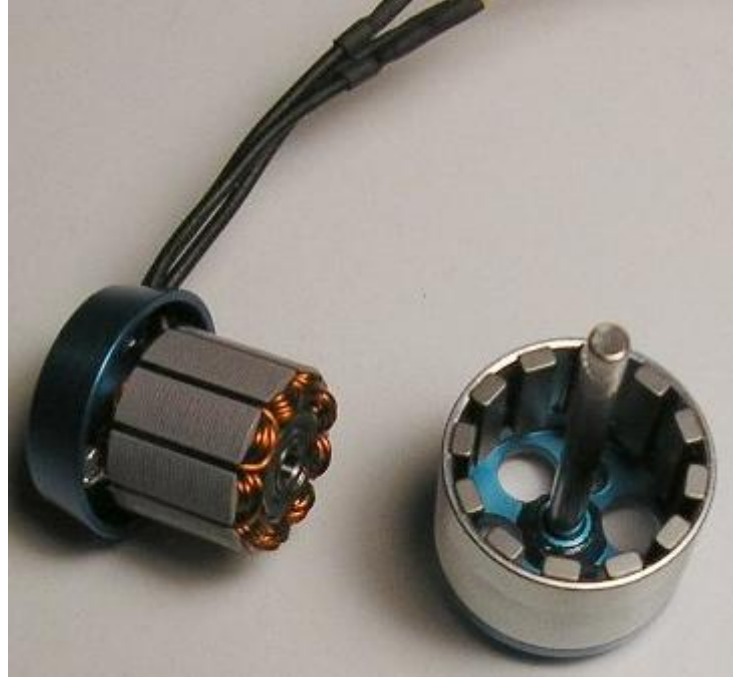
Şekil 4.3. Dış rotorlu fırçasız doğru akım motorları.
