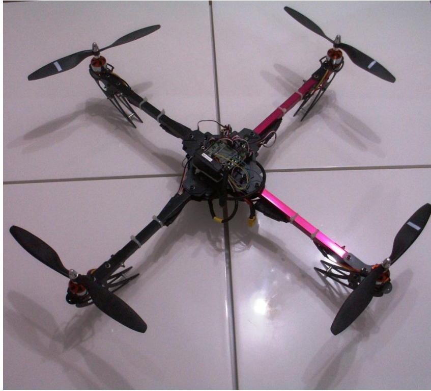
Şekil 1.1. Geliştirilen otonom kontrollü quadrotor robot.
