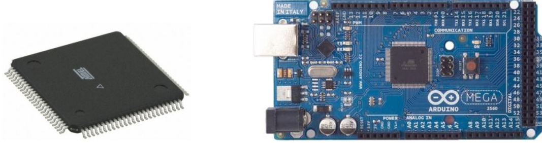
Şekil 4.11. Atmega 2560 denetleyicisi ve arduino mega denetleyici kartı.
