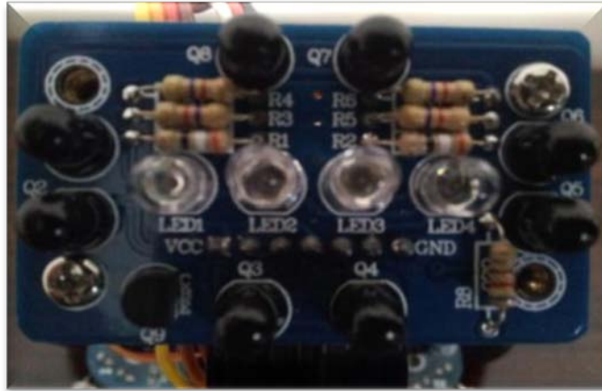
Şekil 3.19. Takipçi Robotun Sensör Devresi
