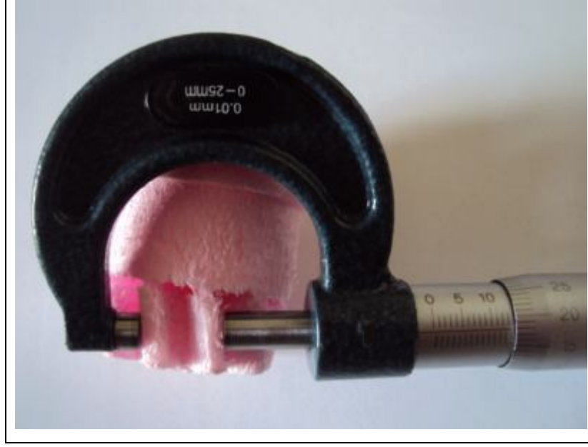
Şekil 5.27. Helisel iki diş arasındaki uzaklığın mikrometre ile ölçümü.
