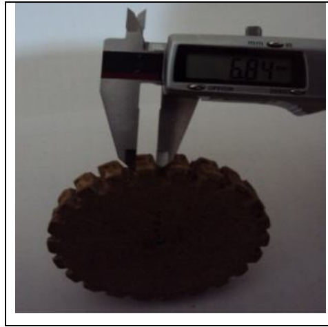
Şekil 5.37. Kumpasla karşılık dişlisi diş kalınlığı ölçümü.
