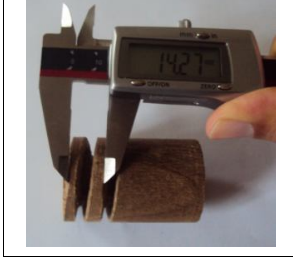
Şekil 5.36. Kumpasla sonsuz vida iki diş arası uzaklık ölçümü.
