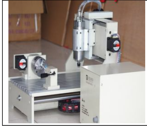
Şekil 2.6. Dört eksen masaüstü CNC freze tezgâhı [29].
