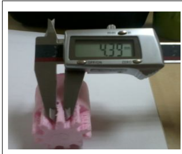
Şekil 5.16. Kumpasla diş kalınlığının ölçülmesi.
