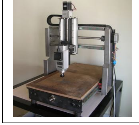
Şekil 2.5. Üç eksen masaüstü CNC freze tezgâhı [28].
