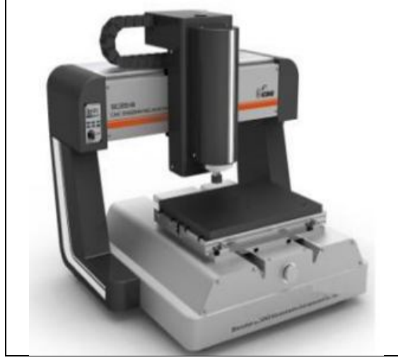
Şekil 2.2. Tabla hareketli masaüstü CNC freze [25].
