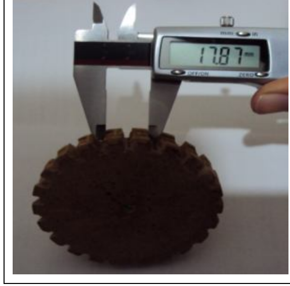
Şekil 5.38. Kumpasla karşılık dişlisi iki diş arası uzaklığın ölçümü.
