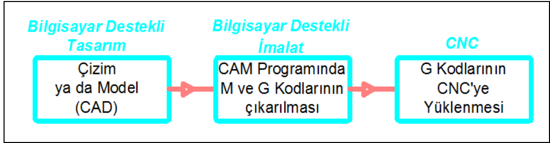
Şekil 2.1. Bilgisayar destekli M ve G kodlarının çıkartılarak CNC arayüz programına yüklenme süreci.
