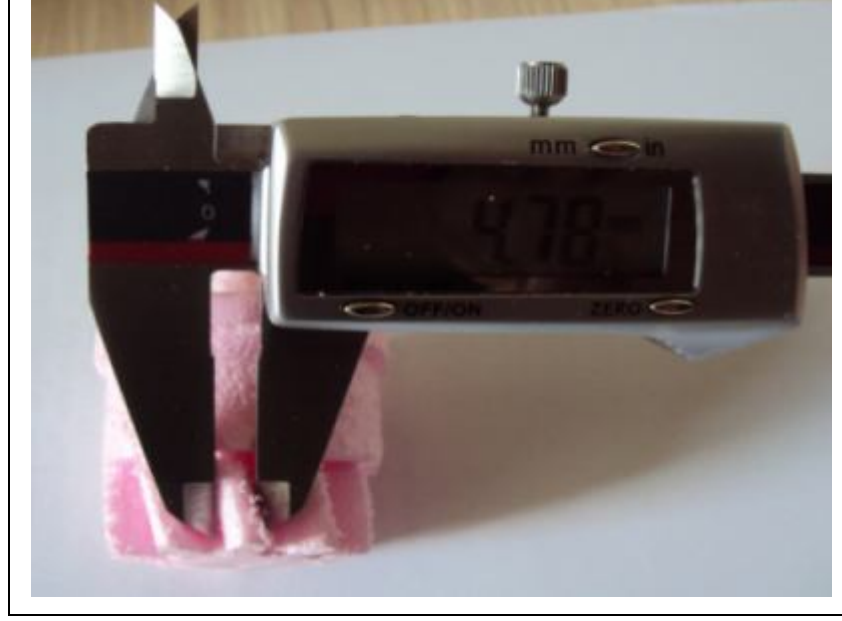
Şekil 5.26. Helisel diş kalınlığının kumpasla ölçümü.
