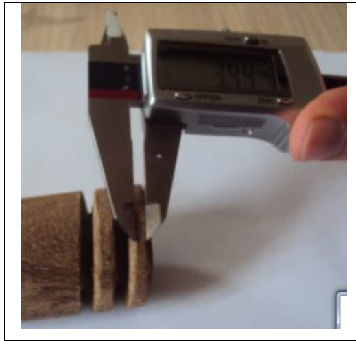
Şekil 5.35. Kumpasla sonsuz vida diş kalınlığı ölçümü.
