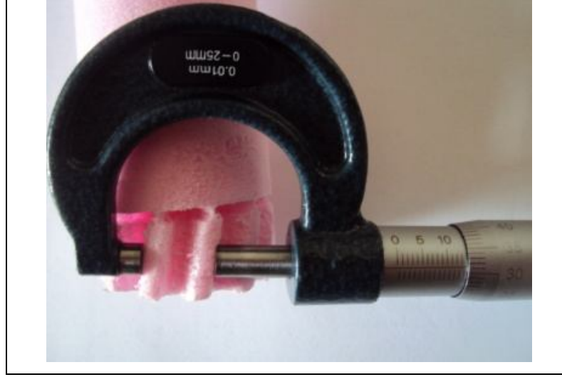
Şekil 5.29. Helisel iki diş arasındaki uzaklığın mikrometre ile ölçümü.
