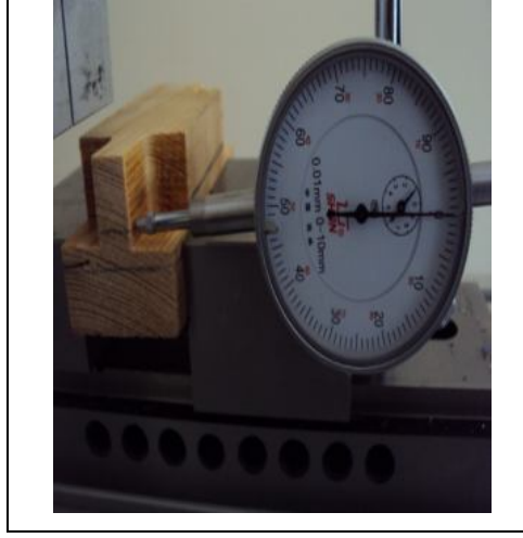
a) Komparatörle Z eksenli diklik ölçümü ayarlamaları.
