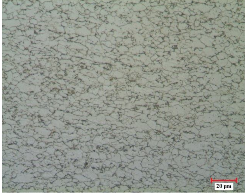
Şekil 5.1. HSLA 7136 kalite ana malzemenin mikroyapı görüntüsü.
