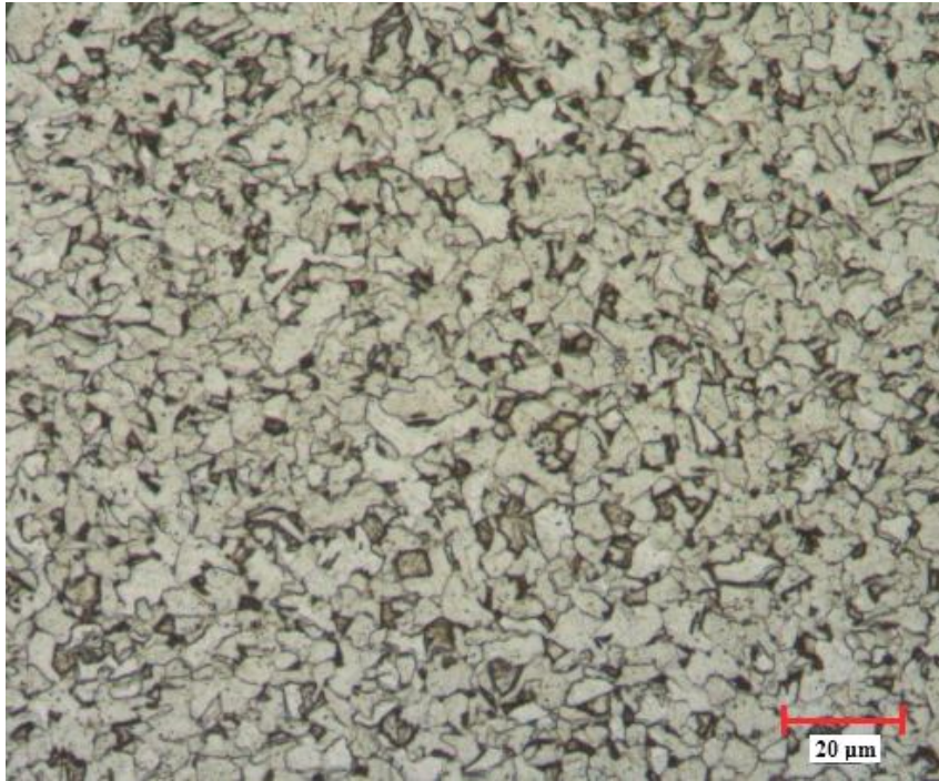
Şekil 5.6. HSLA 7136 kalite çeliğin % 3 öndeformasyona uğrayıp, 350 °C’de 20 dakika süreyle yaşlandırılıp havada soğutulması sonucu oluşan mikroyapı görüntüsü.
