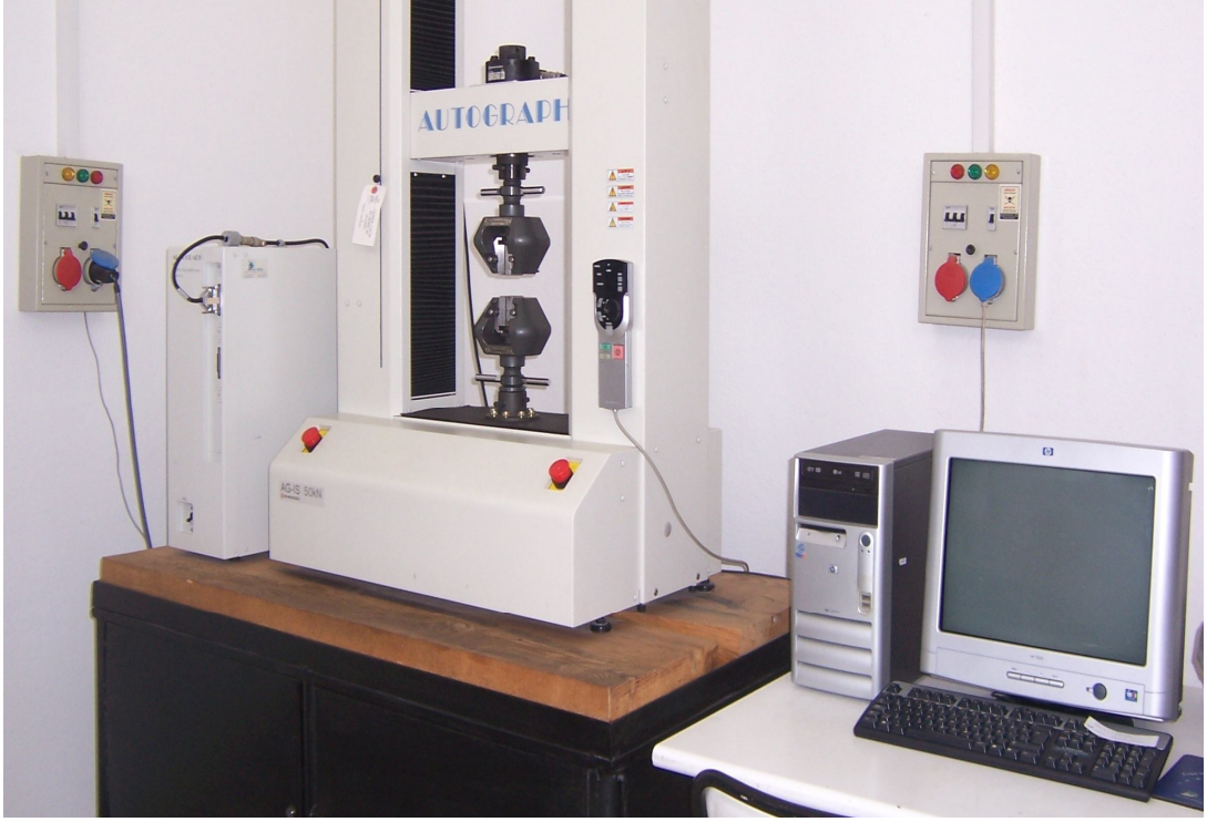
Şekil 4.4. SHİMADZU AG - IS marka 50 KN kapasiteli çekme test cihazı.
