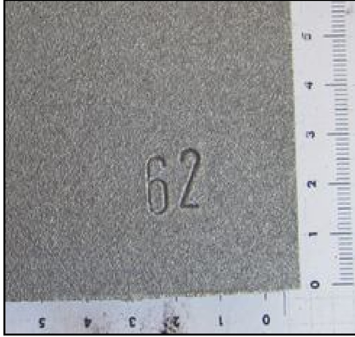
Şekil 5.24. Paslanmış yüzeye sahip St52 çelik numunenin S390 aşındırıcı bilya ile 1,2 m/dk. ilerleme değerinde kumlaması sonucunda elde edilen yüzey görüntüsü.
