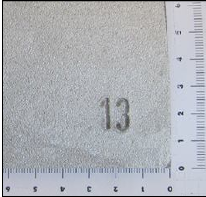
Şekil 5.19. Yüzeyi frezelenmiş St37 çelik numunenin S390 aşındırıcı bilya ile 1,6 m/dk. ilerleme değerinde kumlanması sonucunda elde edilen yüzey görüntüsü.
