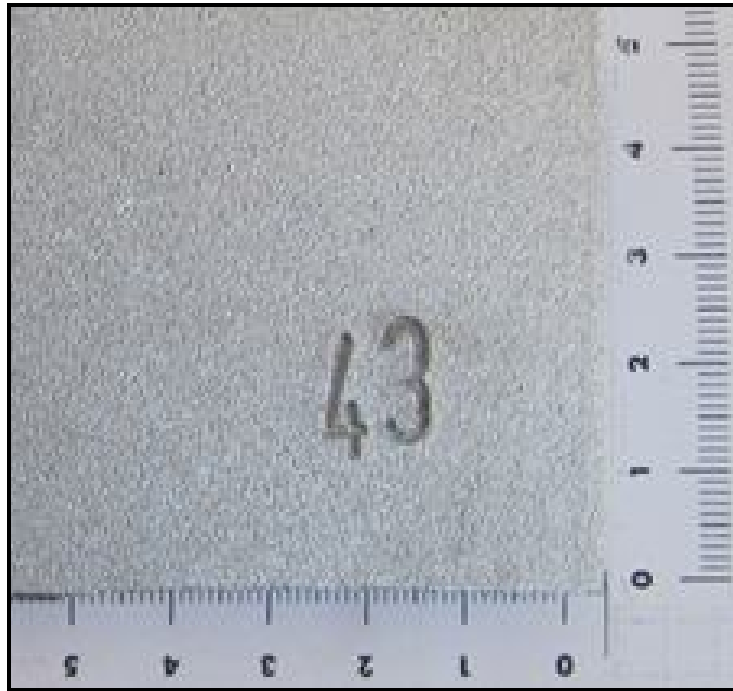
Şekil 5.22. Yüzeyi frezelenmiş St52 çelik numunenin S390 aşındırıcı bilya ile 1,6 m/dk. ilerleme değerinde kumlaması sonucunda elde edilen yüzey görüntüsü.
