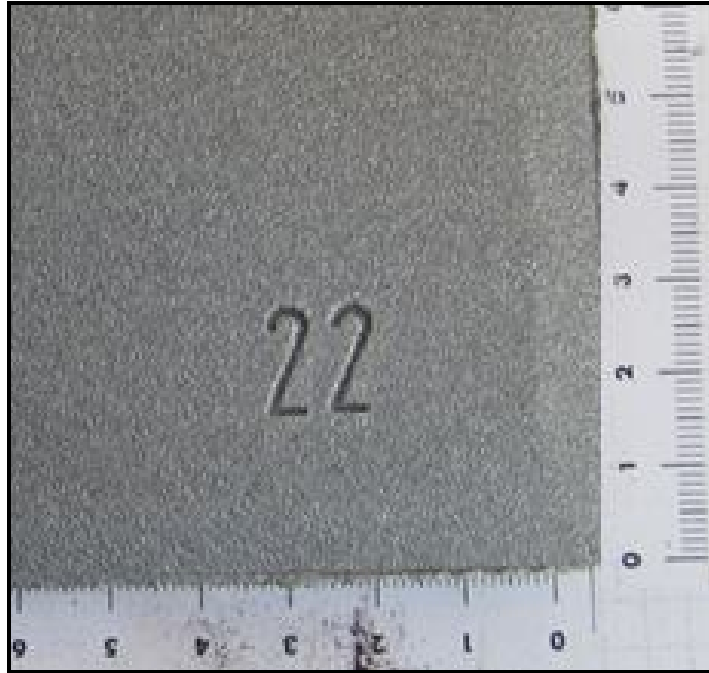
Şekil 5.20. Normal yüzeye sahip St37 çelik numunenin S390 aşındırıcı bilya ile 1,2 m/dk. ilerleme değerinde kumlaması sonucunda elde edilen yüzey görüntüsü.
