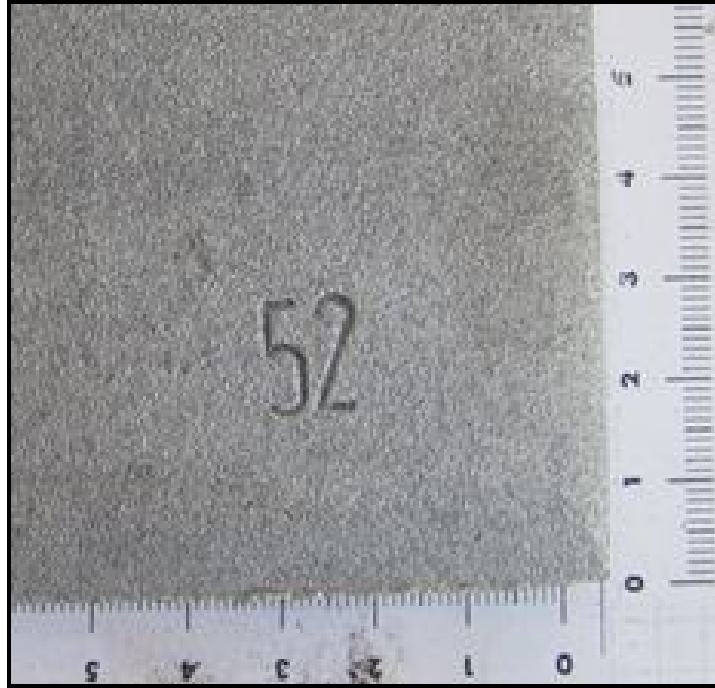
Şekil 5.23. Normal yüzeye sahip St52 çelik numunenin S390 aşındırıcı bilya ile 1,2 m/dk. ilerleme değerinde kumlaması sonucunda elde edilen yüzey görüntüsü.
