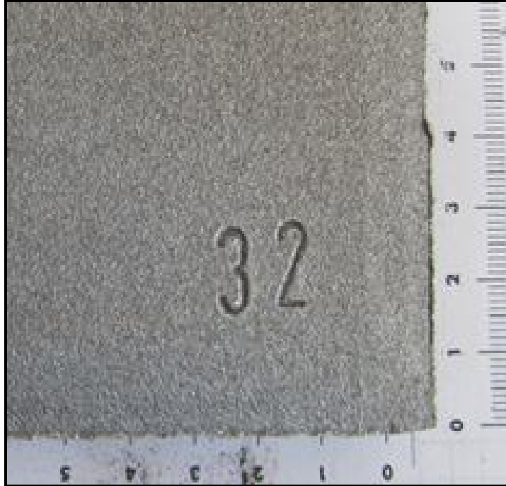
Şekil 5.21. Paslanmış yüzeye sahip St37 çelik numunenin S390 aşındırıcı bilya ile 1,2 m/dk. ilerleme değerinde kumlaması sonucunda elde edilen yüzey görüntüsü.
