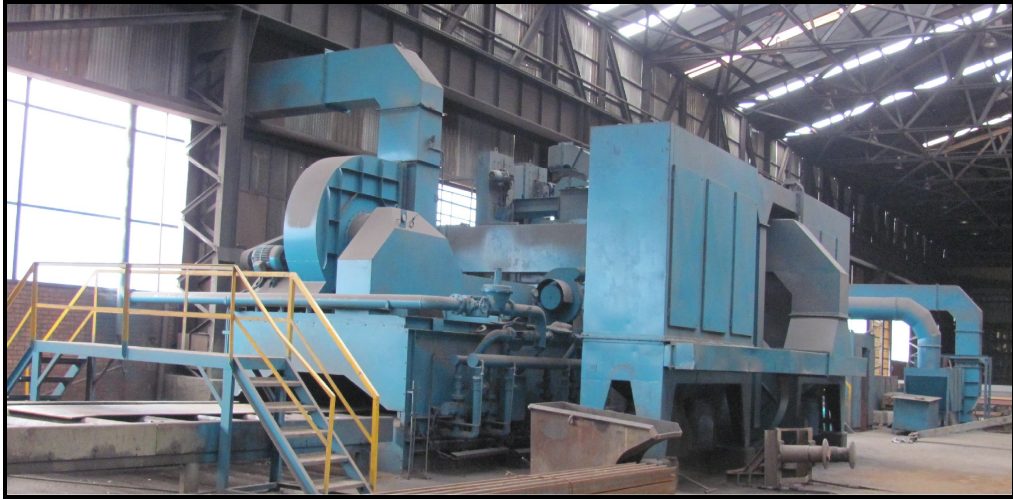
Şekil 4.7. Deneylerde kullanılan türbinli tip kumlama tezgâhi görüntüsü.
