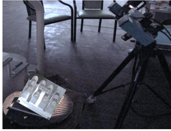
Şekil 3.26. Üç boyutlu optik tarama ile form hatalarının ölçülmesi.
