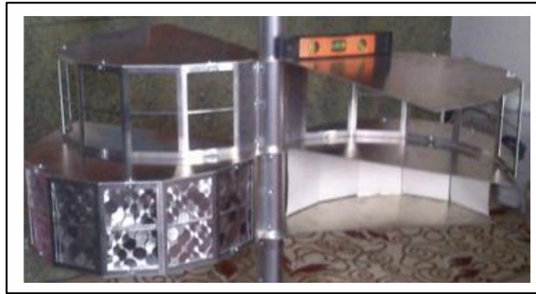
Şekil 3.13. Kanatçık setinin mile montajı.
