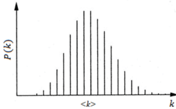
Şekil 3.2. Poisson dağılımına sahip derece dağılımı grafiği.
