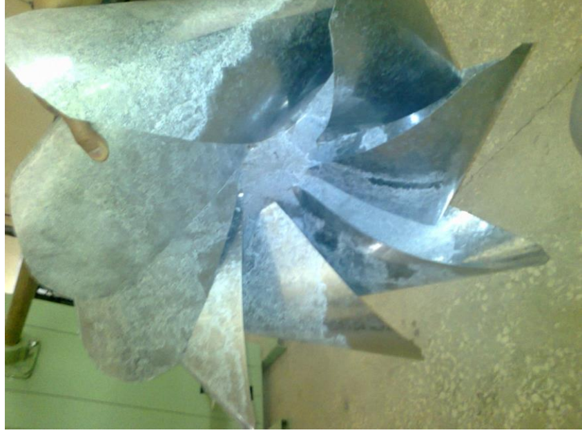
Şekil 3.9. Rüzgâr gülü sekizgen konstrüksiyonu.
