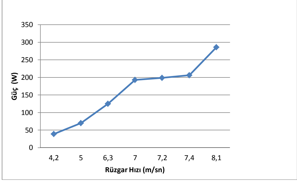
Şekil 4.7. Dörtgen kanatlı rüzgâr güç değişimi.
