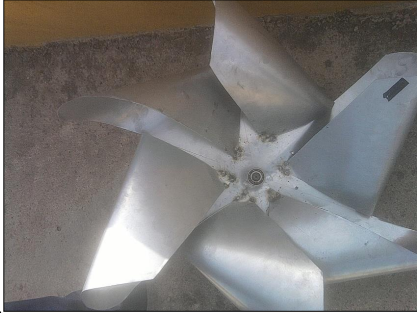
Şekil 3.6. Rüzgar gülü kanat imalat aşamasından bir görüntü.
