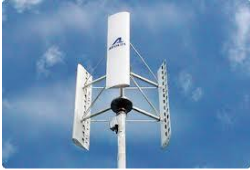
Şekil 2.6. Dikey eksenli rüzgar türbini.
