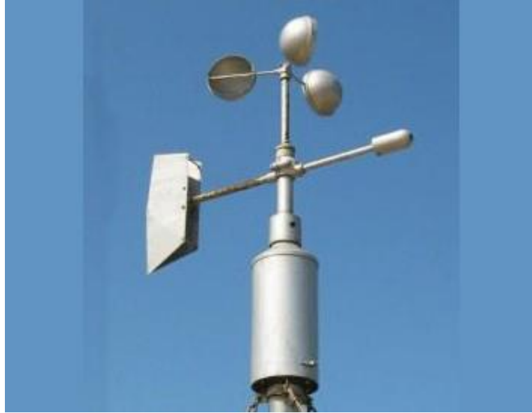
Şekil 3.11. Yaygın olarak kullanılan tipik analog rüzgâr ölçer (anemometre).
