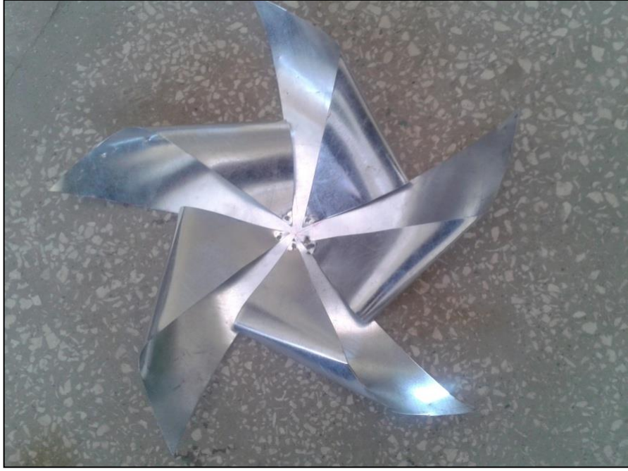
Şekil 3.5. Beşgen rüzgâr türbini kanat tasarım görüntüsü.
