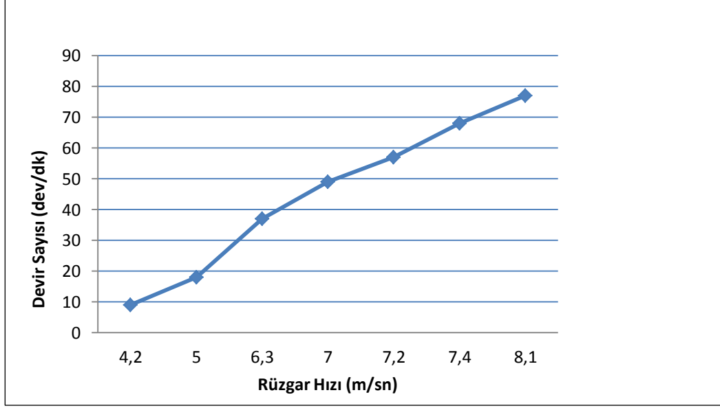
Şekil 4.2. Dört kanatlı rüzgar gülünde devir sayısının rüzgar hızına göre değişimi.
