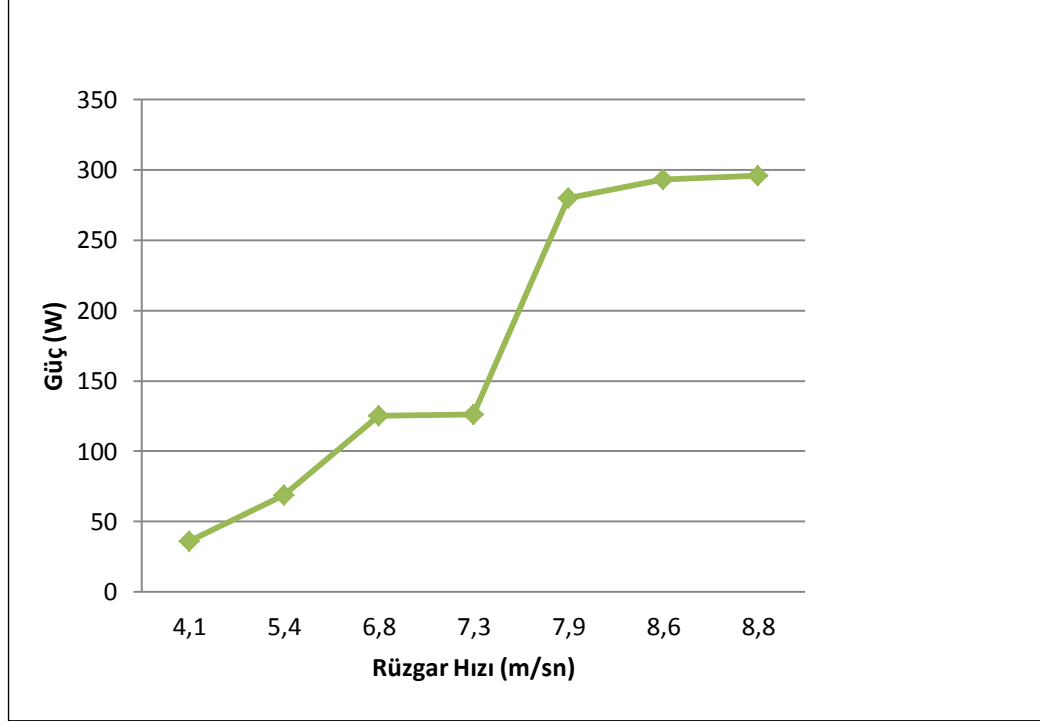
Şekil 4.9. Altıgen kanatlı rüzgâr güç değişimi.
