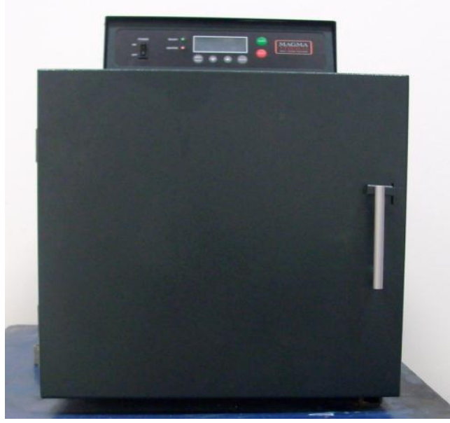
Şekil 4.1. Isıl işlemlerde kullanılan Magma Therm marka sıcaklık kontrollü elektrikli direnç fırını.
