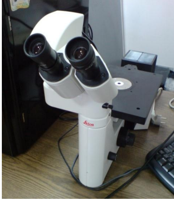
Şekil 4.2. Miroyapı incelemelerinde kullanılan Leica DM ILM model optik ışık mikroskobu.
