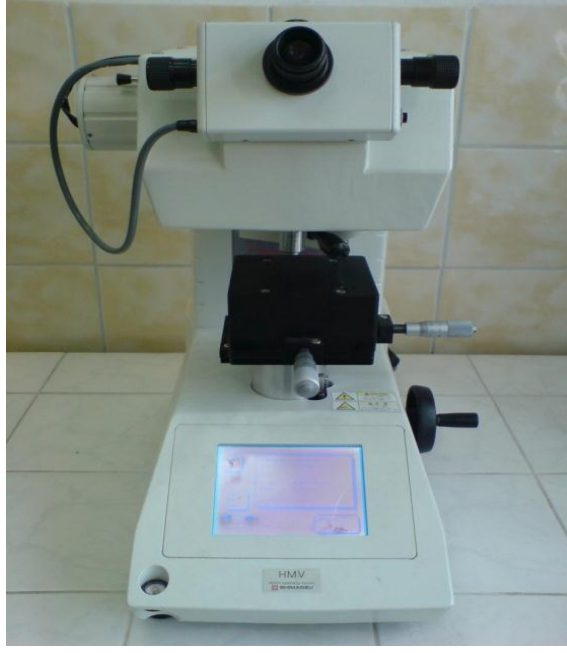
Şekil 4.3. Schimadzu marka HMV Model mikrosertlik cihazı.
