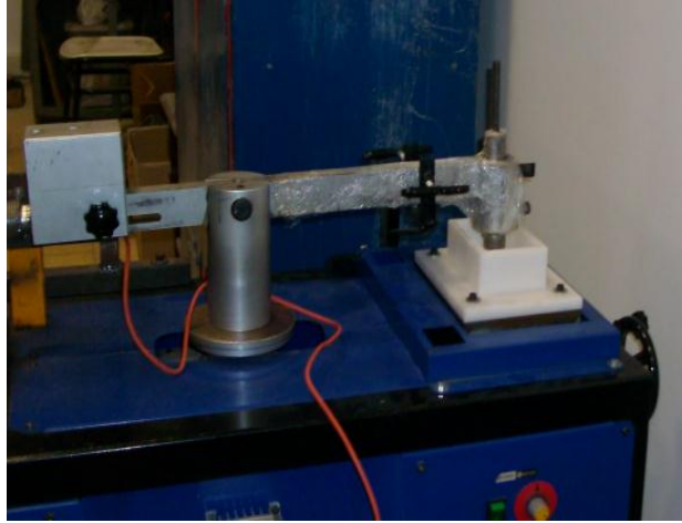
Şekil 4.5. Korozif aşınma deneylerinde kullanılan deney cihazı.
