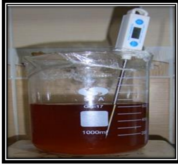
Şekil 5.11. Dijital termometre yakıt sıcaklığının ölçülmesi.
