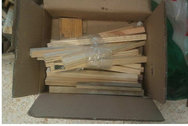
Şekil 4.5. PU, CFRP GFRP ile güçlendirilmiş sarıçam numuneleri
