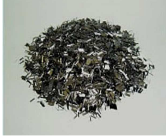
Şekil 3.4. Karbon fiber lifi ve kırılmış elyaf örnekleri (Ünal, 2010).
