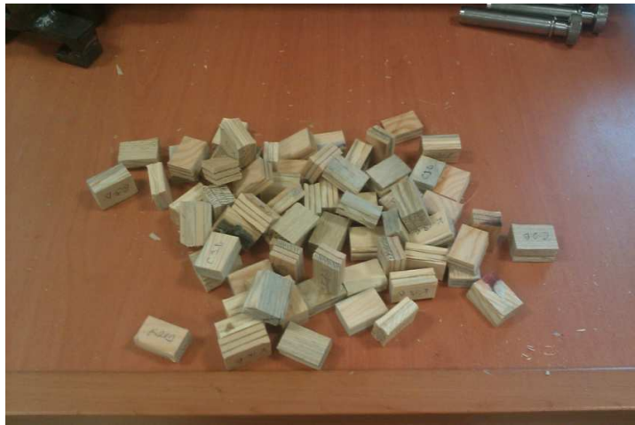
Şekil 4.13. Pu, CFRP ve GFRP ile güçlendirilmiş liflere dik basınç numuneleri
