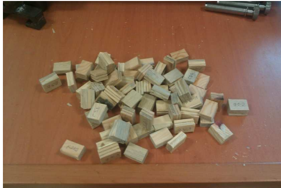
Şekil 4.11. Pu, CFRP ve GFRP ile güçlendirilmiş liflere paralel basınç numuneleri
