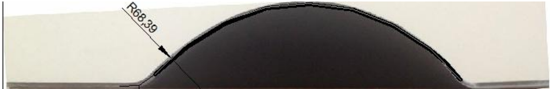
Şekil 7.10. AutoCAD programında gerçekleştirilen deneysel kubbe kavisini ölçümü.
