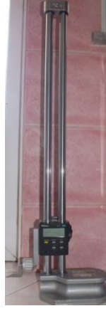
Şekil 7.8. Şişme yüksekliği ölçümlerinin yapıldığı dijital mihengir.
