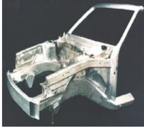
Şekil 2.1. Sac hidro şekillendirme yöntemiyle alüminyum malzemeden üretilmiş Volvo araç gövdesi [16].
