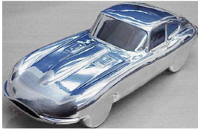
Şekil 3.3. Bir alüminyum tüpün sıcak hidro şekillendirilmesiyle elde edilmiş otomobil modeli, uzunluğu yaklaşık 250 mm (SPS) [39].
