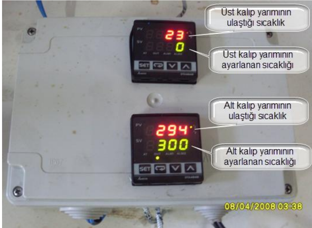
Şekil 6.9. Sıcaklık kontrol ünitesi.
