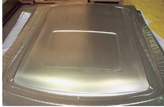
Şekil 3.2. Sac hidroform metoduyla üretilmiş lüks bir otomobil tavan elemanı [39].
