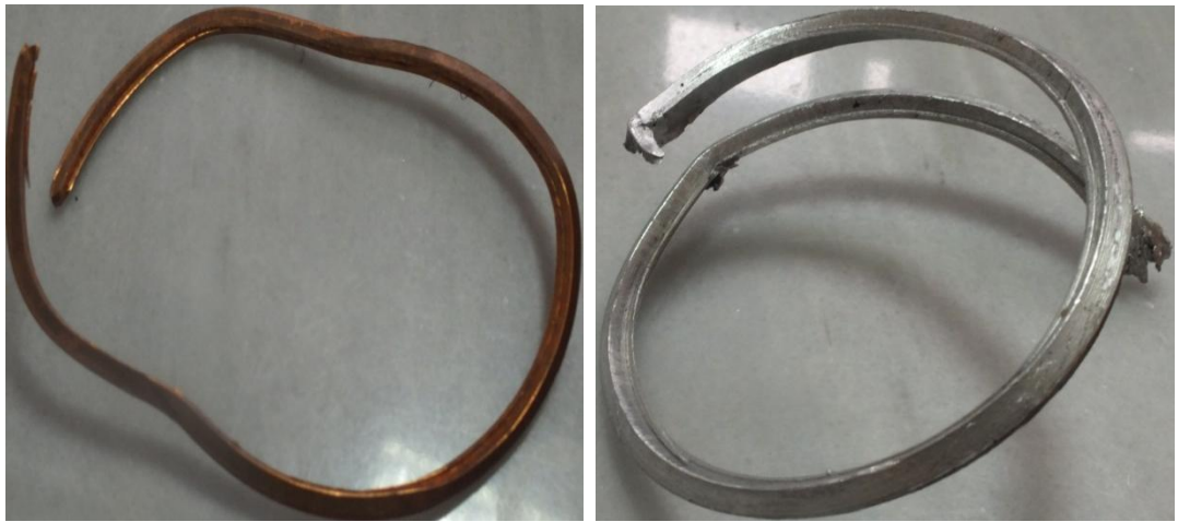
Şekil 7.9. Hidro şekillendirme işlemi için hazırlanan bakır ve alüminyum pullar.
