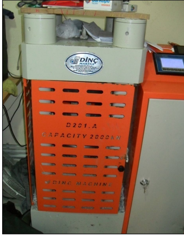
Şekil 3.16. Basınç dayanımı testinde kullanılan test cihazı.
