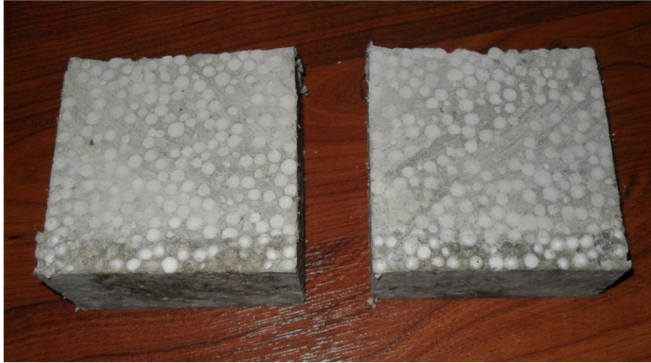
Şekil 3.19. Hafif betonda kullanılan EPS dağılımı.
