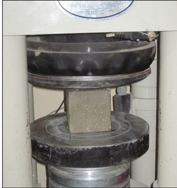
Şekil 3.17. Numunenin test cihazına yerleştirilmesi.
