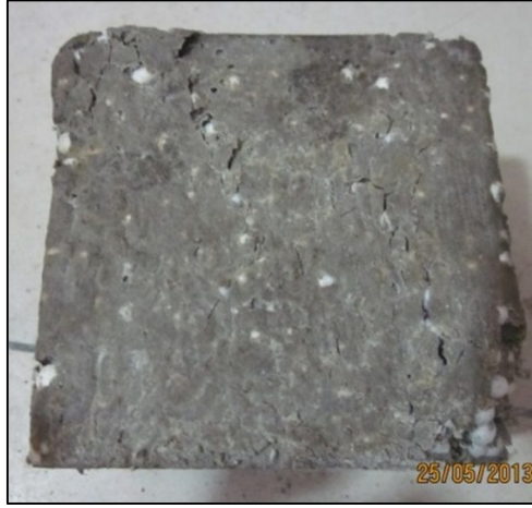
Şekil 3.18. Basınç dayanımı testi yapılan numunenin son hali.
