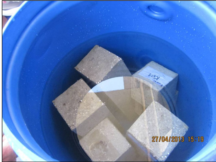
Şekil 3.12. Su dolu kaptan kürlenme süresini bekleyen deney numuneleri.
