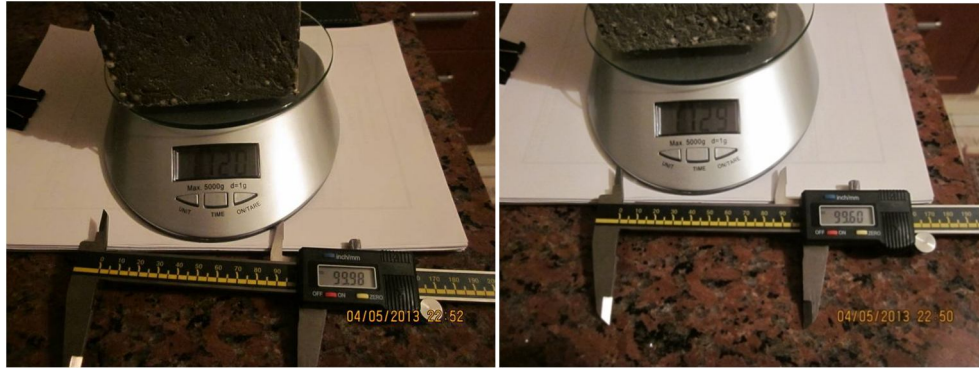
Şekil 3.13. % 1 oranında EPS katılan hafif beton numunenin 7. gün su emme ve rötire ölçümü.
