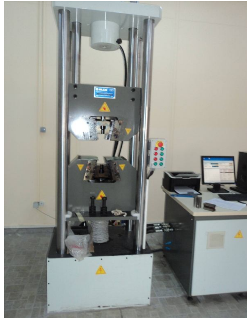
Şekil 4.3. Çekme deneylerinde kullanılan 50 tonluk Alşa marka çekme cihazı.
