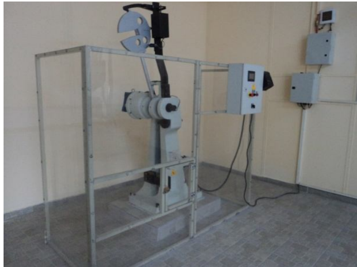
Şekil 4.5. 300 JOULE enerjili Alşa marka darbe-çentik cihazı.
