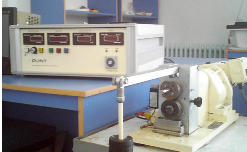
Şekil 4.2. Abrasif aşınma testlerinde kullanılan cihaz.
