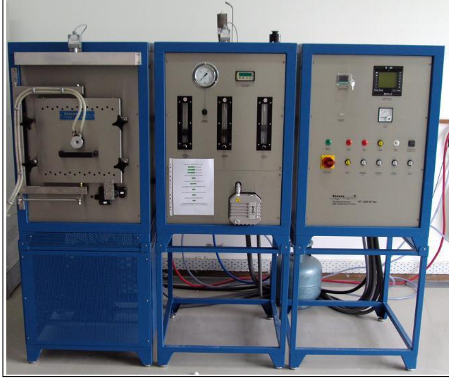
Şekil 5.5. Sinterlemelerin yapıldığı LINN marka HT-1800-M-Vac model fırın.
