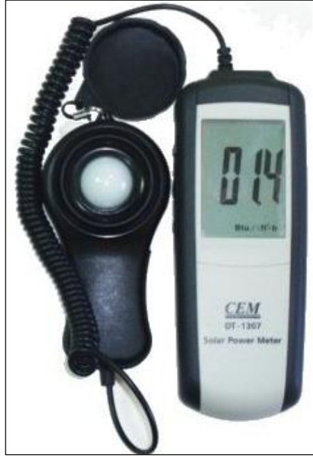
Şekil 4.1. Işınım şiddetini ölçen solarimetre.
