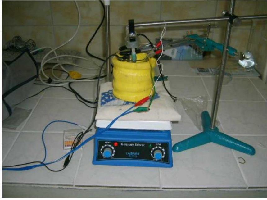
Şekil 6.3. Statik korozyon deney hücresi.
