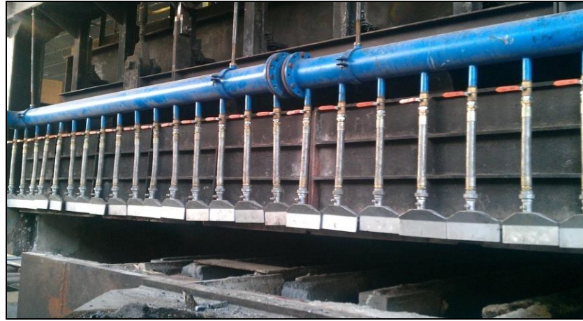
Şekil 3.9. Endüstriyel tav fırında hava perdesi montajının görünüşü.
