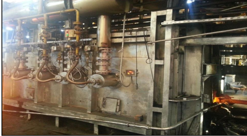
Şekil 1.7. Doğalgaz ile çalışan endüstriyel bir tav fırını.
