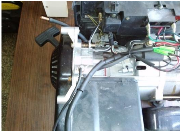
Şekil 3.5. Motor yay-karbüratör vakum mekanizması.
