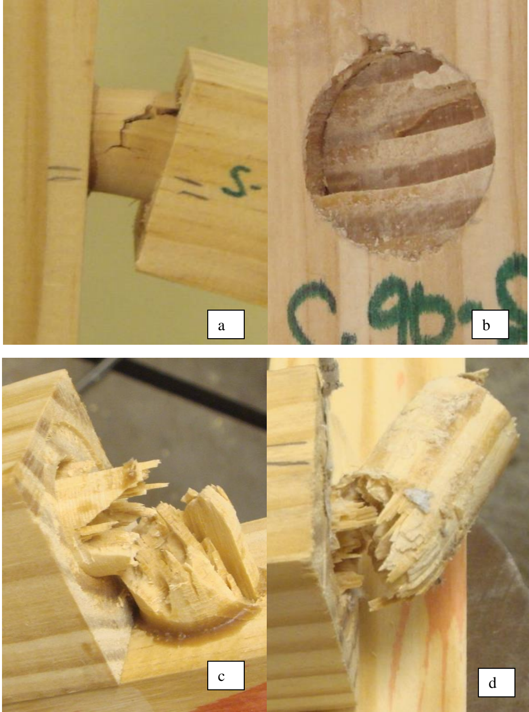
Şekil 5.7. Daire kesit formlu zıvanalı T-tipi köşe birleştirme deneylerdeki oluşan deformasyonlar a) Kırılma esnası, b) zıvanada meydana gelen makaslama yarılması, c) zıvananın kırılması, d) zıvananın kırılması.
