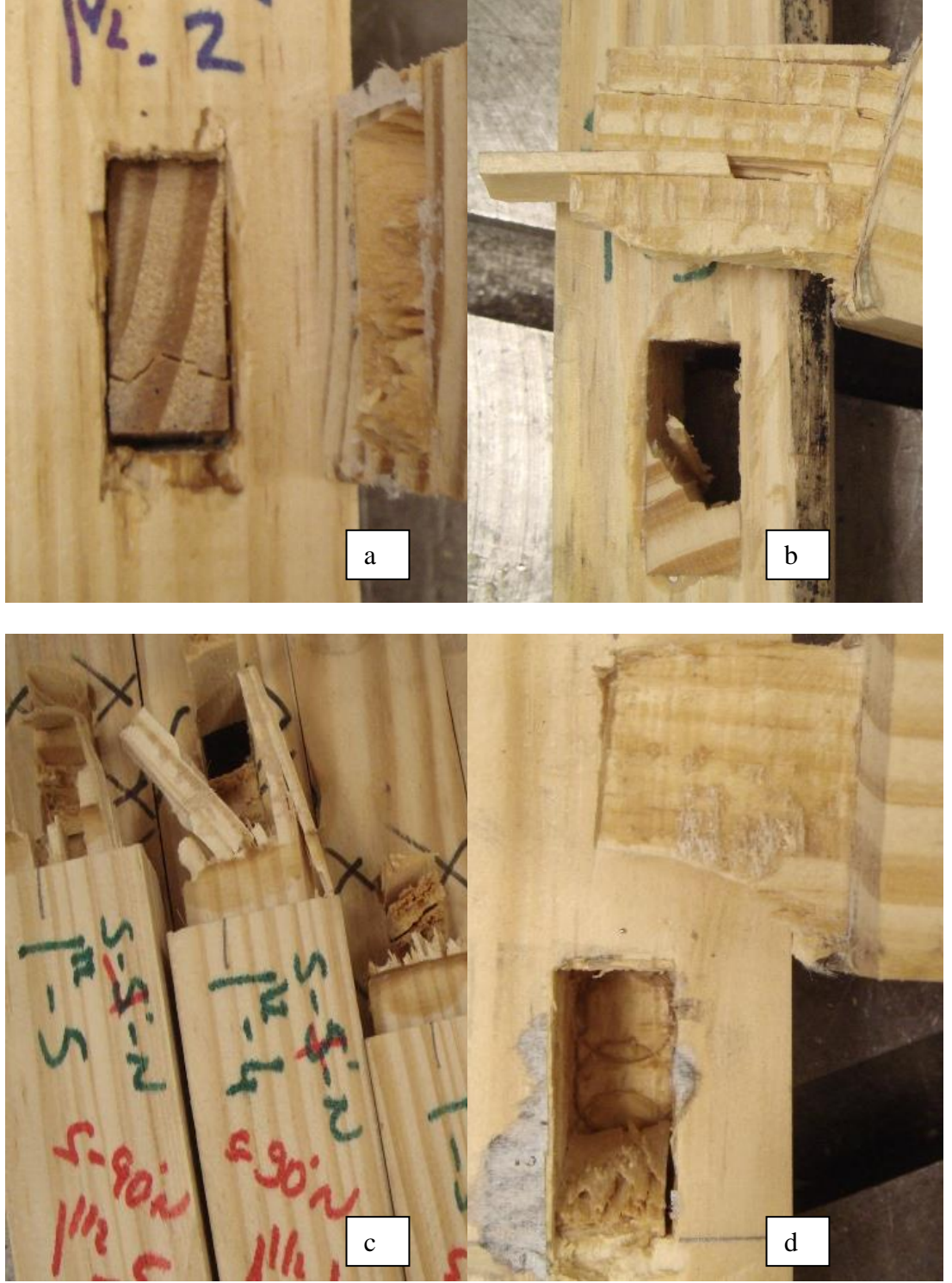
Şekil 5.6. Dikdörtgen kesit formulu zıvanalı T-tipi köşe birleştirme deneylerdeki oluşan deformasyonlar a) Kırılma başlangıcı, b) Makaslama yarılmaları, c) Kırılma sonrası, d) zıvanada meydana gelen ezilme ve yarıлма.
