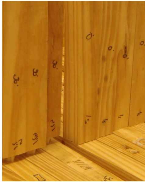
Şekil 4.5. T-tipi mobilya köşe birleştirmelerde alın etkisi.
