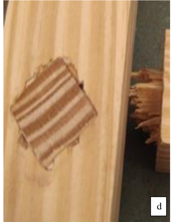
Şekil 5.8. Köşegen kesit formulu zıvanalı T-tipi köşe birleştirme deneylerdeki oluşan deformasyonlar a) birleştirmede oluşan açılmalar, b) makaslama yarılmaları, c) zıvananın kırılma sonrası, d) zıvananın kırılma sonrası kesit yüzeyi.
