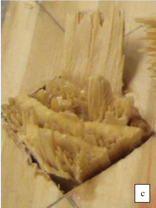
Şekil 5.8. Köşegen kesit formulu zıvanalı T-tipi köşe birleştirme deneylerdeki oluşan deformasyonlar a) birleştirmede oluşan açılmalar, b) makaslama yarılmaları, c) zıvananın kırılma sonrası, d) zıvananın kırılma sonrası kesit yüzeyi.
