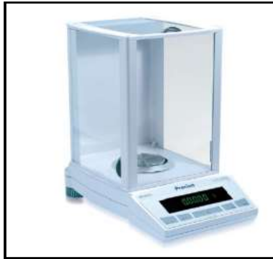
Şekil 5.5. Precisa XB200h marka hassas terazi.
