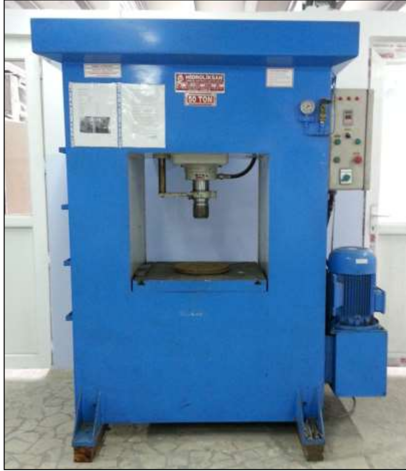
Şekil 5.2. Ön şekillendirme sırasında kullanılan Hidroliksan marka pres.
