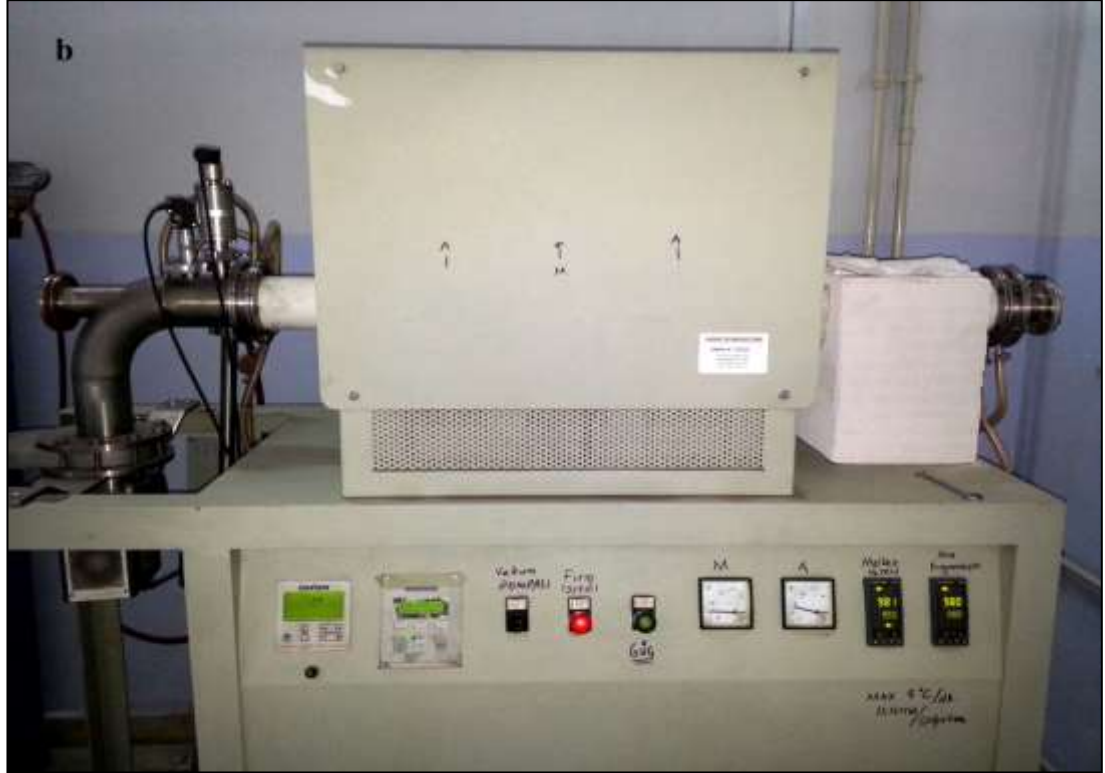
Şekil 5.3. Monel alaşımlarının a)Sinterleme işlem şeması, b)Sinterlemelerin yapıldığı Alcatel marka ACT-200 model fırın
