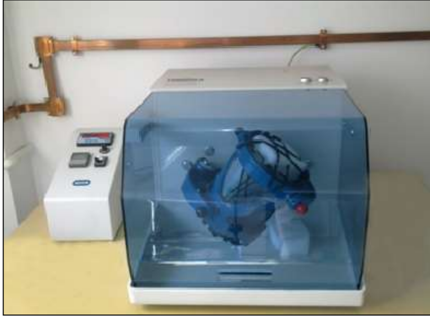
Şekil 5.1. Turbula® Shaker Mixer (Model T2F Glenn Mills) karıştırıcı.
