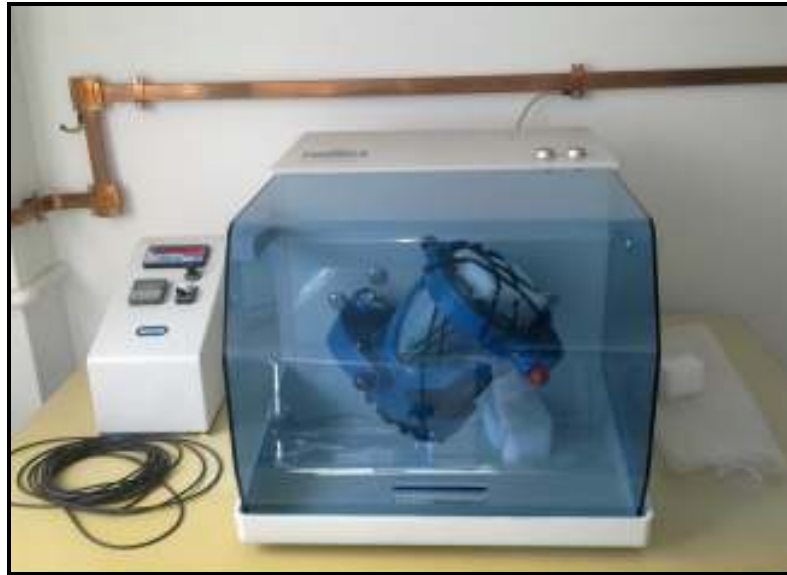
Şekil 5.2. Elementel tozların karıştırılmasında kullanılan Turbula® Shaker Mixer (Model T2F Glenn Mills) tipi karıştırıcı.
