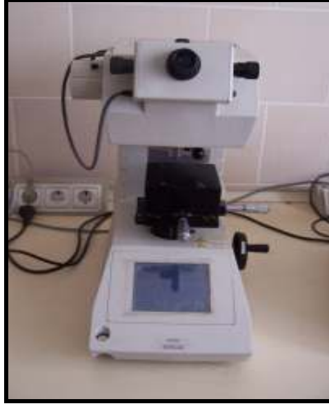
Şekil 5.9. SHIMADZU marka (HMV) sertlik ölçüm cihazının görüntüsü.
