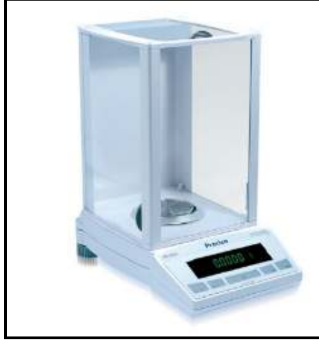
Şekil 5.1. Precisa XB200h marka hassas terazi ve yoğunluk ölçüm seti.
