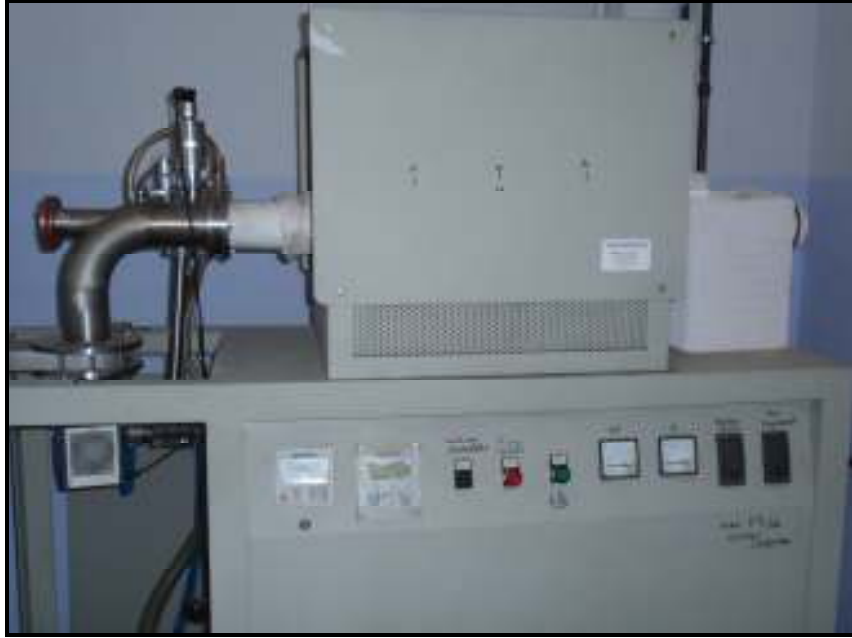
Şekil 5.4. Thermal Technology GMBH marka ısıtıl işlem fırını.
