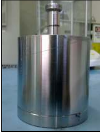
Şekil 5.3. Numunelerin şekillendirilmesinde kullanılan metal kalıp.
