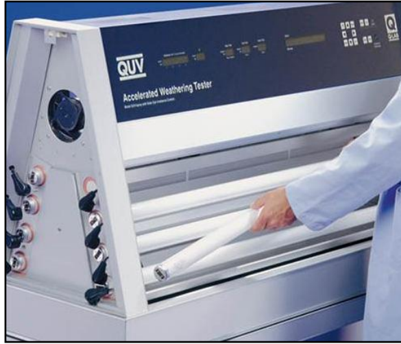
Şekil 2.3. UV-B 313 Lambaların montajı (Anonim 2013).
