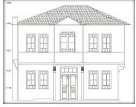
Şekil 3.112. Ön cephe görünüş çizim.
