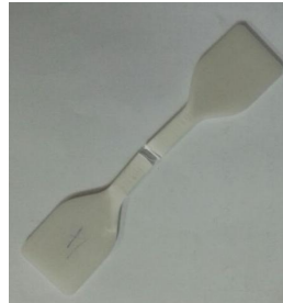
Şekil 4.3. Çekme testi sonucunda elde edilen kopmuş %95 PP %5 ahşap tozu numunesi.
