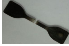
Şekil 4.7 Çekme testi sonucunda elde edilen kopmuş %80 PP%20 ahşap tozu numunesi.
