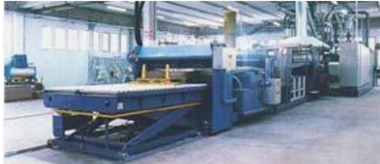
Şekil 2.9. Ahşap plastik kompozit profil üretim hattı [17].
