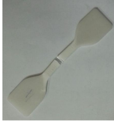
Şekil 4.1 Çekme testi sonucunda elde edilen kopmuş PP numunesi.
