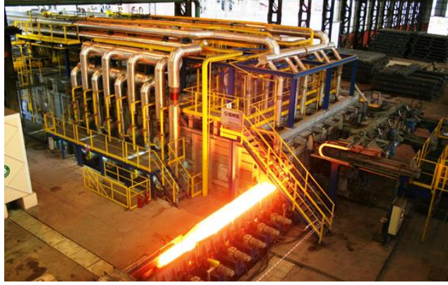
Şekil 1.5. Endüstriyel bir tav fırını resmi.
