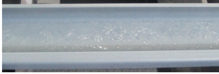
Şekil 5.3. Üretim hattından geçirilen sıcak ray ve üzerindeki üretim seri numaraları.
