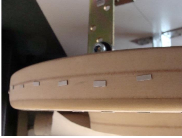
Şekil 4.3. Disk üzerine oluşturulan yapay kusurlar.
