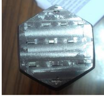
Şekil 4.7. Ray üzerinde kusur oluşturulmak için imal edilen çekiç resmi.
