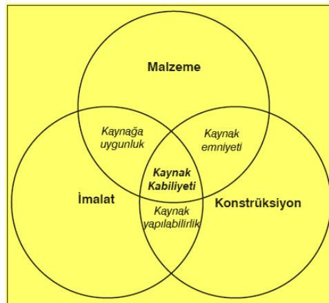
Şekil 4.1. Kaynak kabiliyetinin temel faktörler ve özelliklerle ilişkisi [40].
