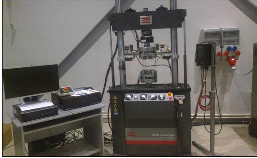
Şekil 6.9. Çekme deneylerinin yapıldığı test cihazı.
