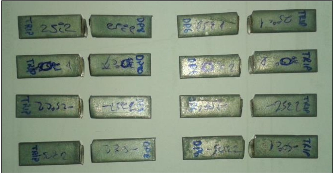
Şekil 7.25. Çentik darbe deneyi sonucu kopan numune fotoğrafı.
