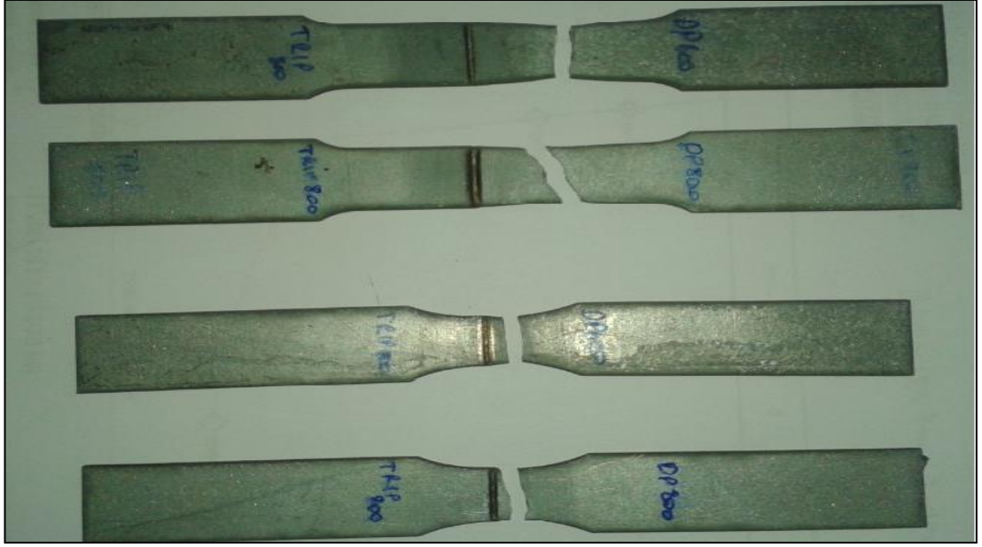
Şekil 7.30. Çekme deneyi sonucu koparılan numune fotoğrafı (UR – R).
