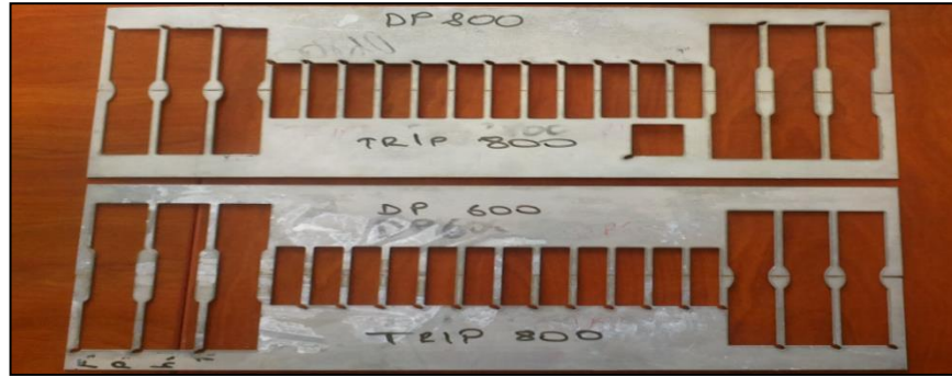
Şekil 6.10. Su jeti ile kesilmiş olan çekme ve darbe çentik numunelerinin gösterimi.
