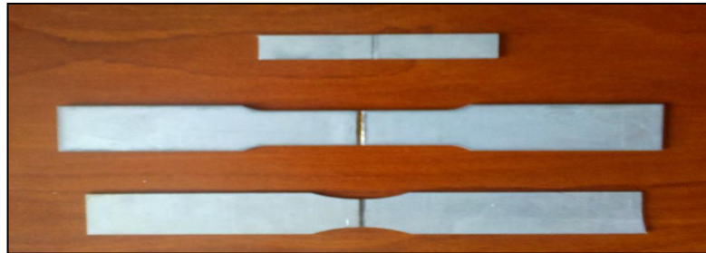
Şekil 6.11. Su jeti ile kesilmiş olan çekme ve darbe çentik numuneleri.
