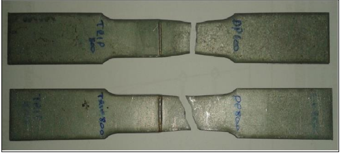
Şekil 7.32. Çekme deneyi sonucu koparılan numune fotoğrafı (R).
