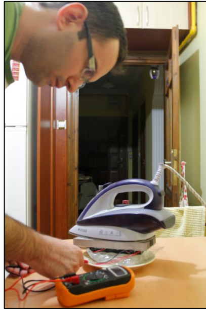
Şekil 4.4. Resistans ve buzun oluşturduğu sıcaklık farkıyla elektrik üretimi.
