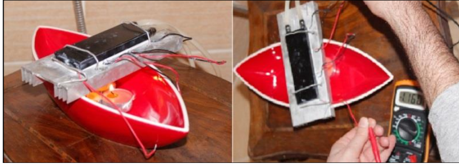
Şekil 4.5. Mum ve soğutma suyunun oluşturduğu sıcaklık farkıyla elektrik üretimi.
