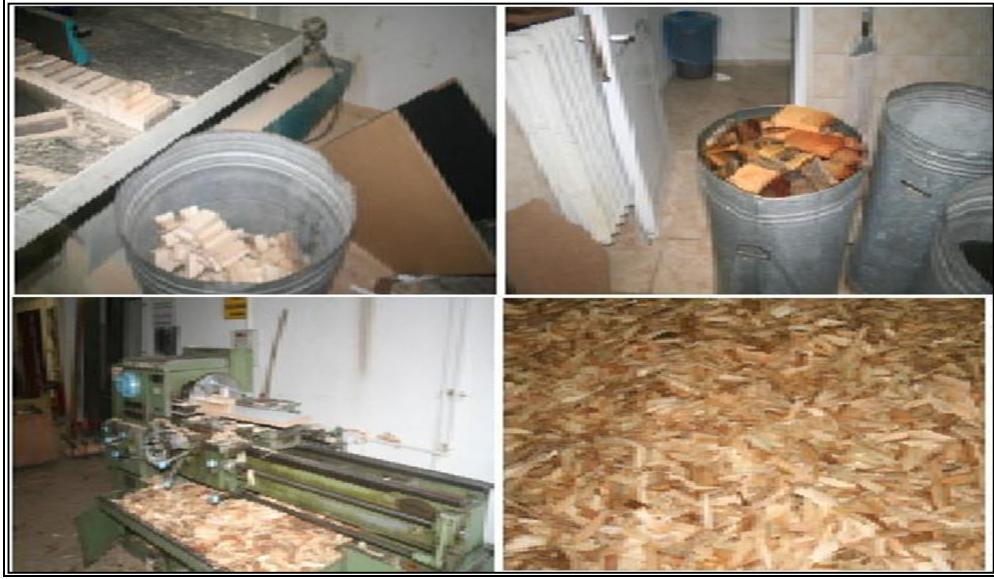
Şekil 6.1. Yönlendirilmiş yongalevha (OSB) üretiminde kullanılacak strandlerin elde edilme işlemleri.
