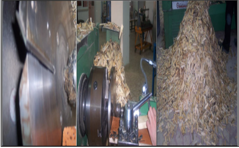
Şekil 6.3. Diskli yongalayıcı ve yongalar (Strander ve strandler).
