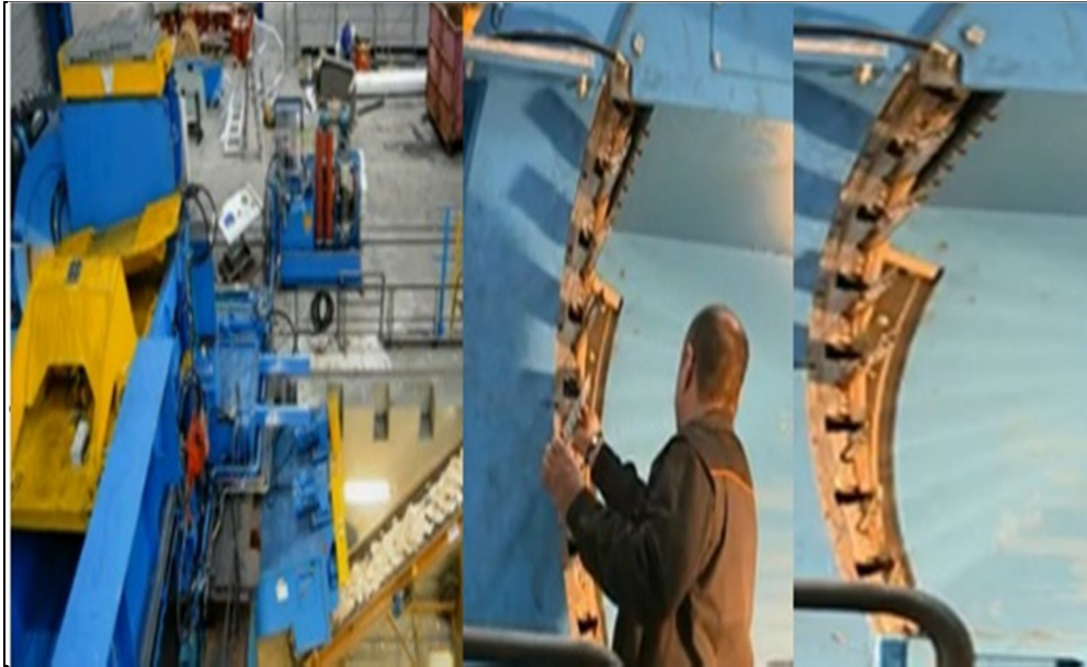
Şekil 4.3. Silindirik kaba yongalama makinesi ve halkalı flaker.
