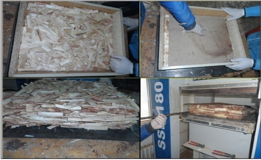
Şekil 6.6. OSB serme ve presleme işlemleri.
