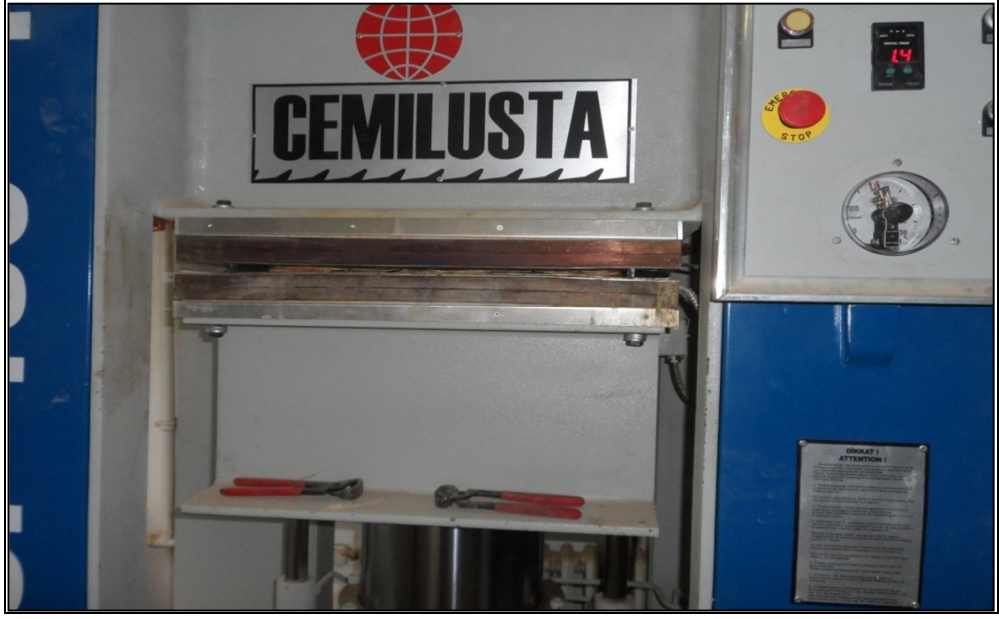
Şekil 6.7. Levha taslağının preslenmesi.
