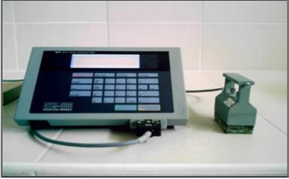
Şekil 6.9. Isı iletim katsayısı ölçüm cihazı.
