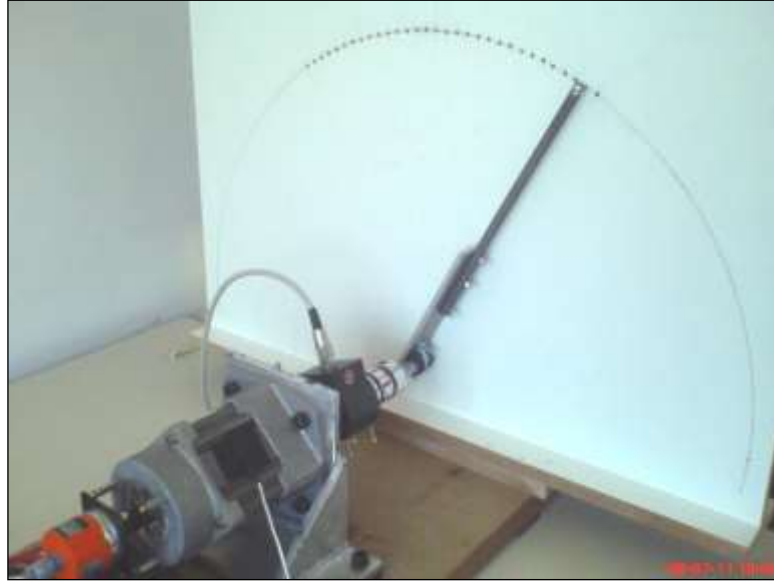
Şekil 4.8. ARM rotor konumuna göre faz endüktans ölçüm deney düzeneği.
