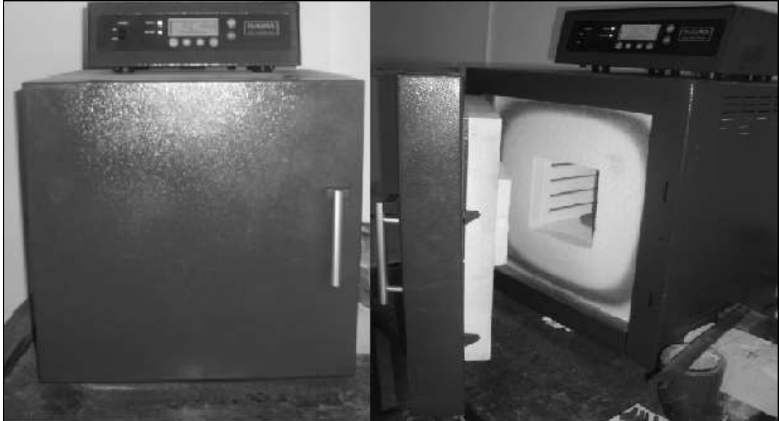
Şekil 4.3. Isıl işlemlerde kullanılan Magma Therm marka sıcaklık kontrollü elektrikli direnç fırını.
