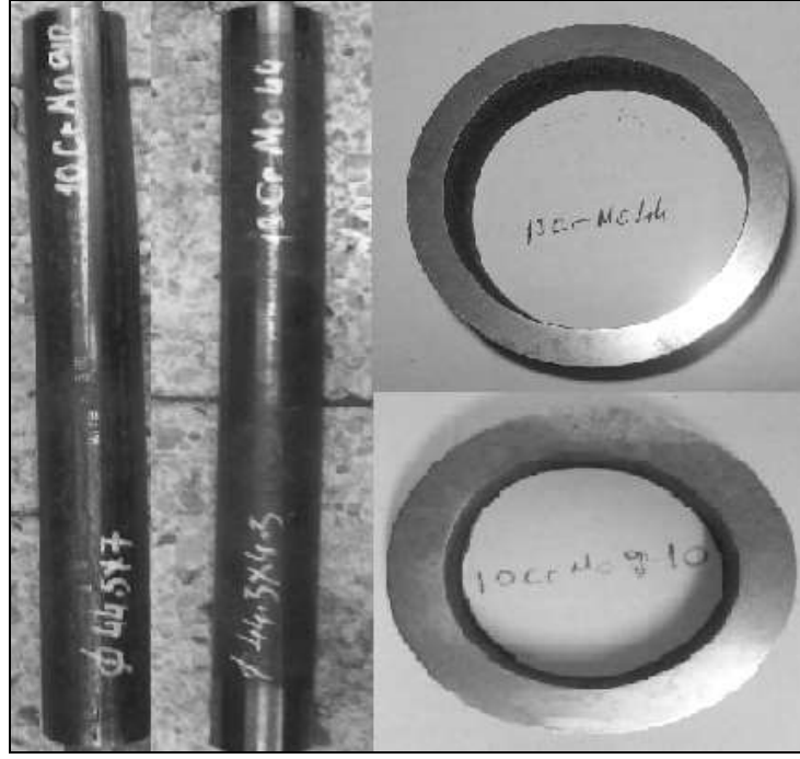
Şekil 4.1. Boru numune ve metacut metkon kesme diski ile kesilmiş 10 mm kalınlıktaki malzemeler.
