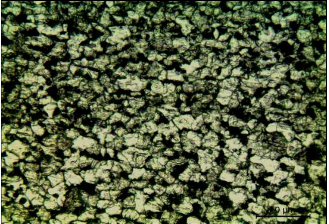
Şekil 5.10. 1 Cr'lu 900 °C'de 1 saat östenitleme işlemi uygulanmış 650 °C'de 12 saat temperlenmiş çelik (40x).
