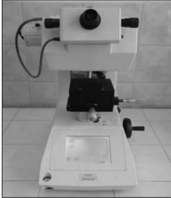
Şekil 4.5. Schimadzu marka HMV model mikrosertlik cihazı.
