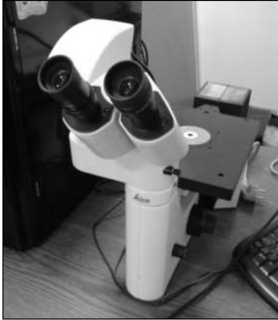
Şekil 4.4. Mikroyapı incelemelerinde kullanılan Leica DM ILM model optik ışık mikroskobu.
