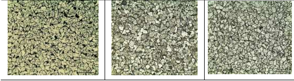
Şekil Ek A.4. 1 Cr'lu 960 °C'de östenitlenmiş çeliklerin optik mikroskop görüntüleri.
