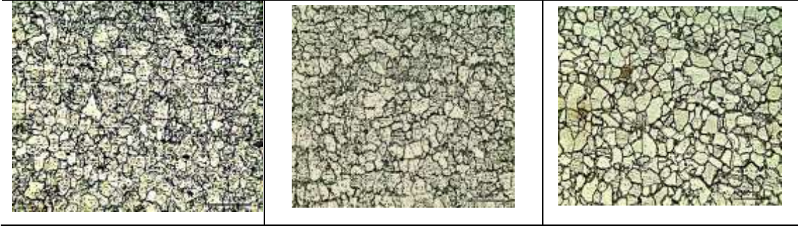
Şekil Ek A.5. 1 Cr'lu 900 °C'de östenitlenmiş çeliklerin optik mikroskop görüntüleri.
