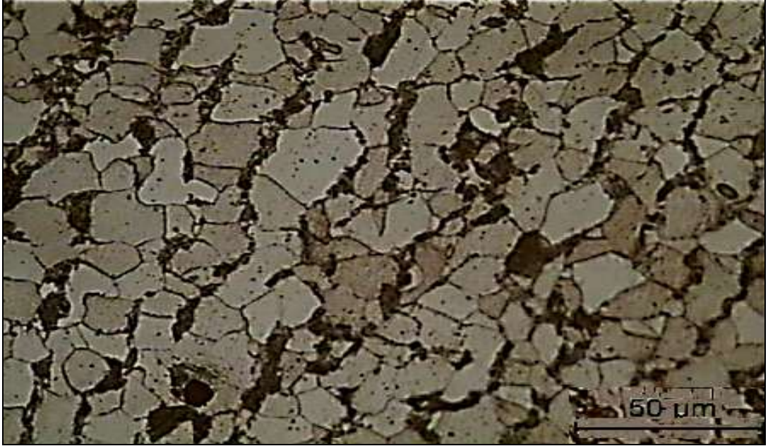
Şekil 5.7. 1 Cr'lu orijinal çeliğin optik mikroskop görüntüsü (40x).
