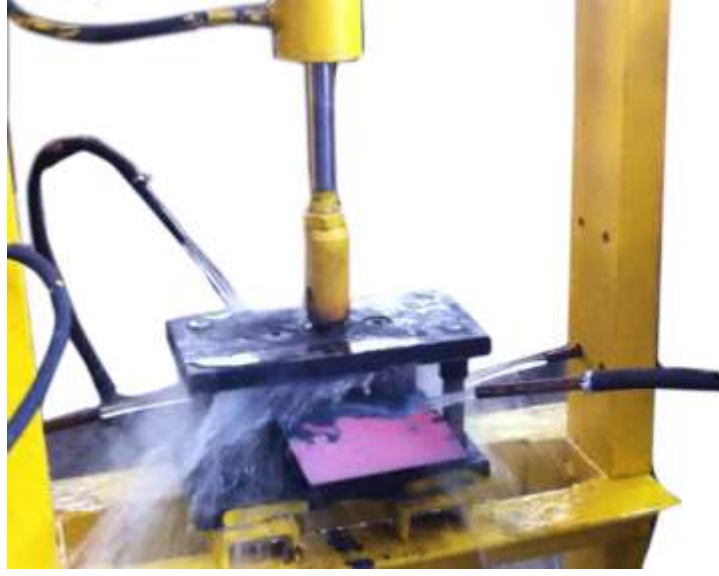
Şekil 4.4. Preste eş zamanlı şekillendirme ve su verme işlemi.
