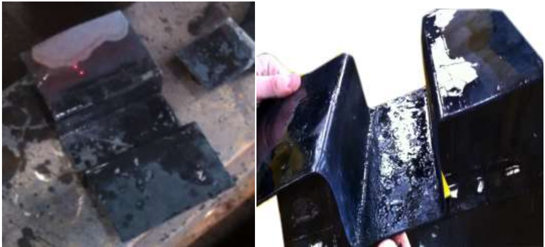
Şekil 4.5. Preste eş zamanlı şekillendirilmiş ve su verilmiş numuneler.
