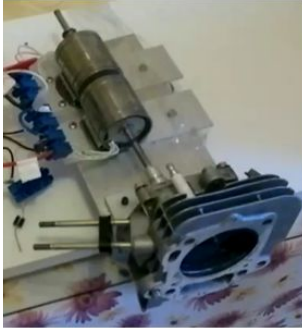
ekil 5.5. EMS sisteminin emme supabına ve silindir kapa ına montajı.
