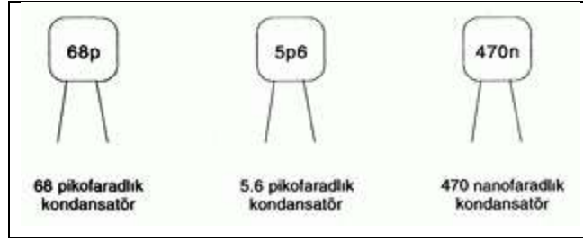
Şekil 2.13. Kondansatörün değerinin okunması.
