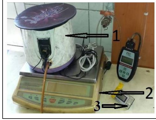
Şekil 6.17. Ölçümlerde kullanılan, 1-Yakıt kabı, 2-Dijital terazi, 3-Kronometre.
